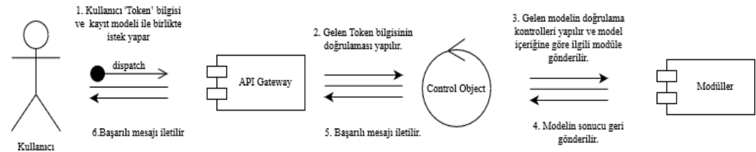
Şekil 4.11 : Sisteme kayıt ekleme kullanım senaryosu için normal senaryo İBD 1.
