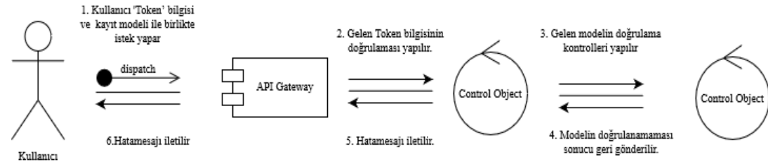
Şekil 4.14 : Sisteme kayıt ekleme kullanım senaryosu için anormal senaryo İBD 2.
