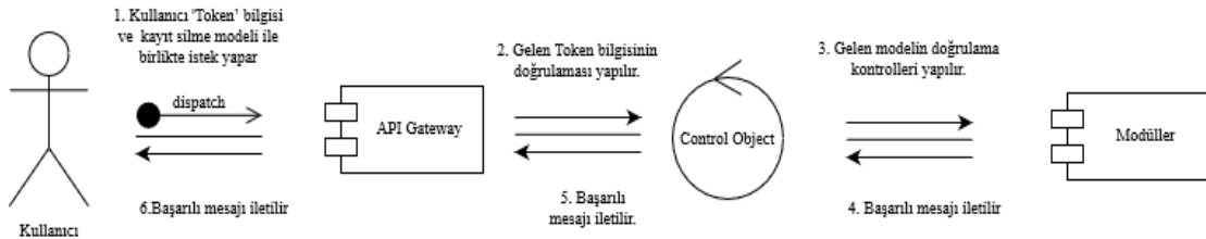
Şekil 4.33 : Sistemdeki kayıtları silme kullanım senaryosu için normal senaryo İBD 4.
