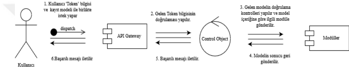
Şekil 4.15 : Sisteme kayıt ekleme kullanım senaryosu için normal senaryo İBD 3.
