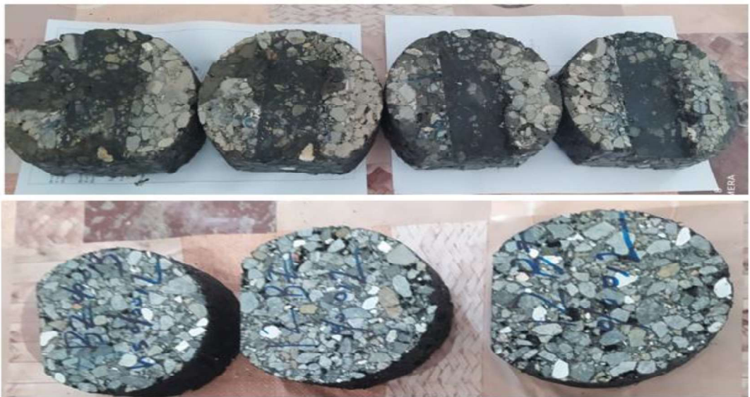
Şekil 4.19: Hamburg Tekerlek izi deneyi sonrası numuneler ve kesitleri
