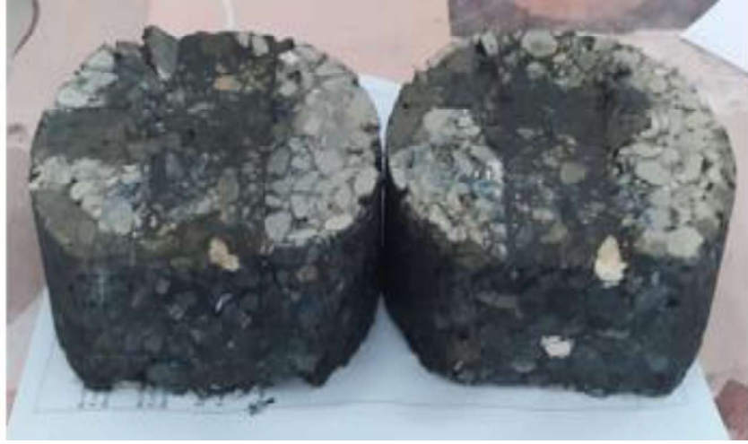
Şekil 4.20: Test numunelerinde oluşan tekerlek izi derinliği
