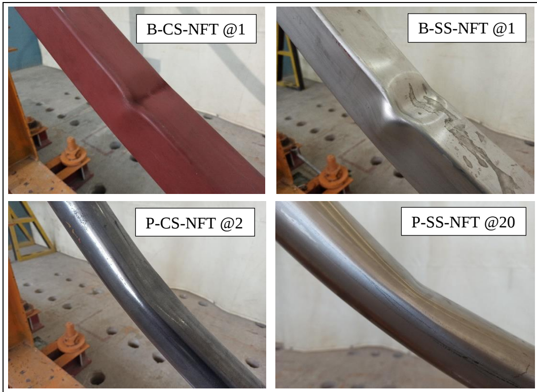
Şekil 3.14. NFT serisi deney numunelerinde yerel burkulma
