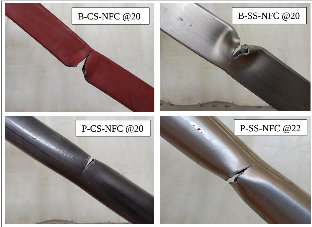
Şekil 3.11. NFC serisi deney numunelerinde kopmadan hemen önceki hasar durumu
