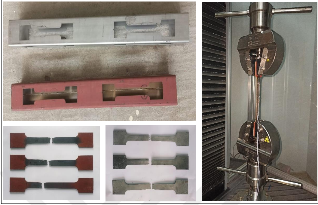
Şekil 2.2. Çekme deneyleri yapılan paslanmaz ve karbon numuneler
