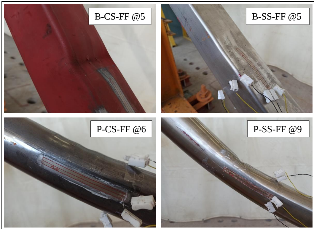
Şekil 3.4. FF serisi deney numunelerinde lokal burkulma
