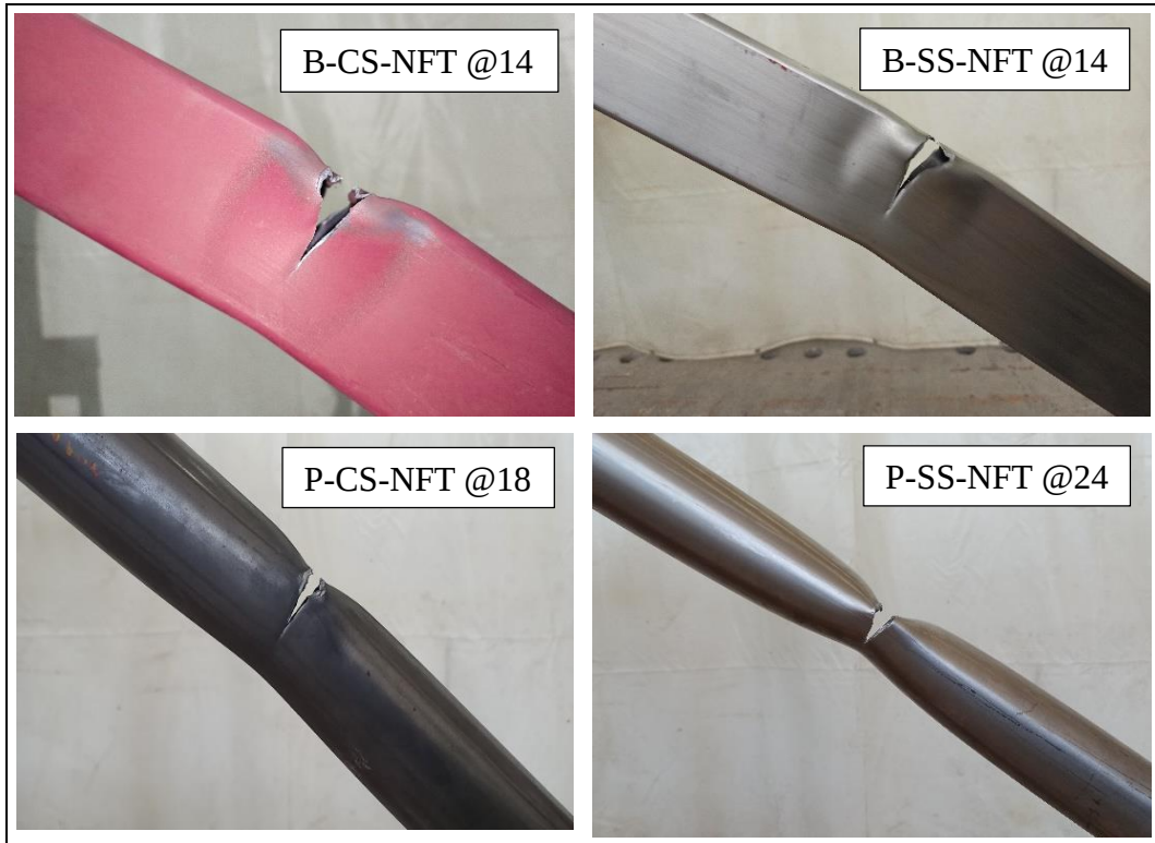
Şekil 3.16. NFT serisi deney numunelerinde kopmadan hemen önceki hasar durumu
