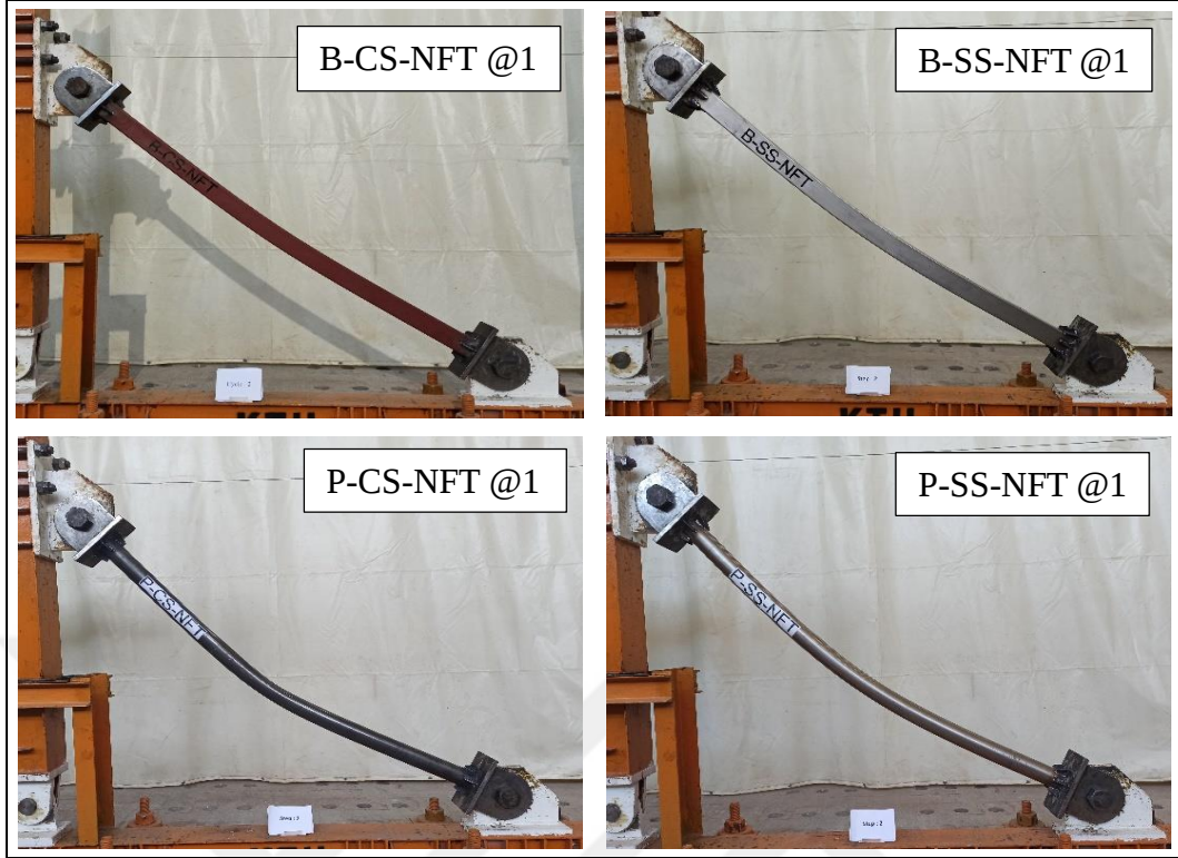
Şekil 3.13. NFT serisi deney numunelerinde genel burkulma
