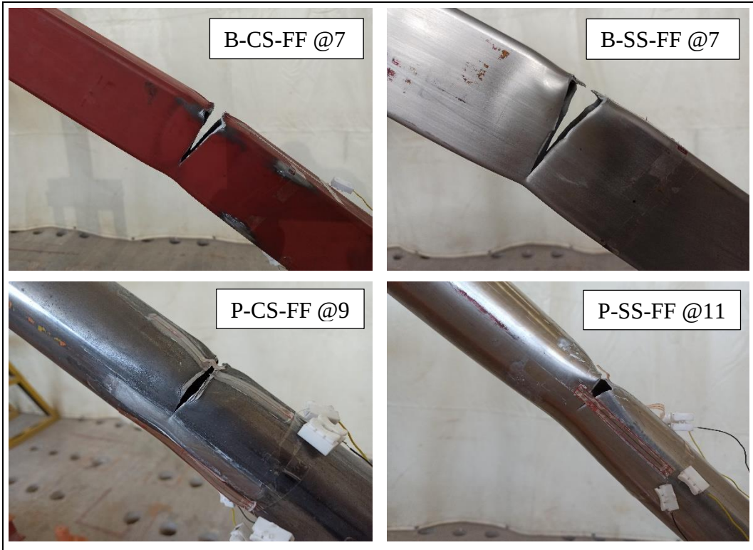
Şekil 3.6. FF serisi deney numunelerinde kopmadan hemen önceki hasar durumu
