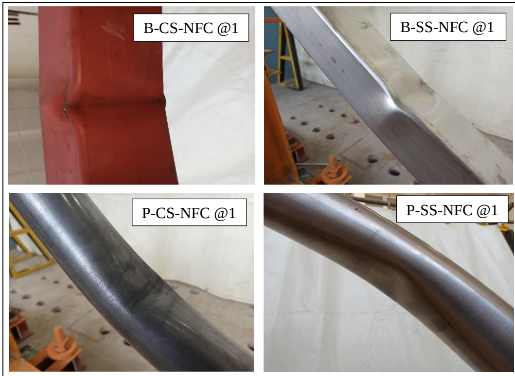
Şekil 3.9. NFC serisi deney numunelerinde yerel burkulma
