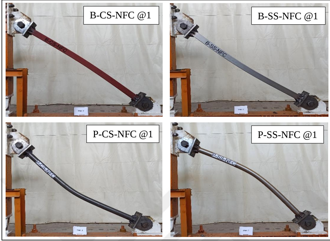
Şekil 3.8. NFC serisi deney numunelerinde genel burkulma
