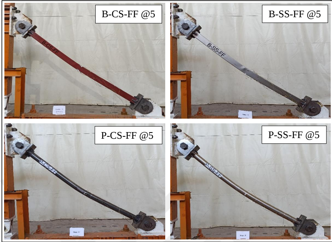
Şekil 3.3. FF serisi deney numunelerinde genel burkulma
