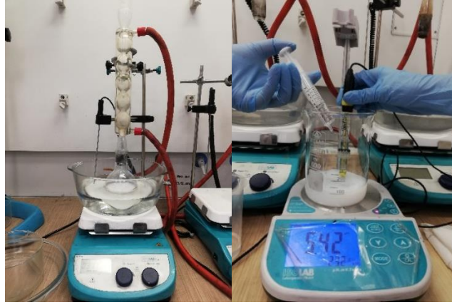
Şekil 3.8 Silanlama işlemi için kurulan düzenek ve pH ayarlanması
