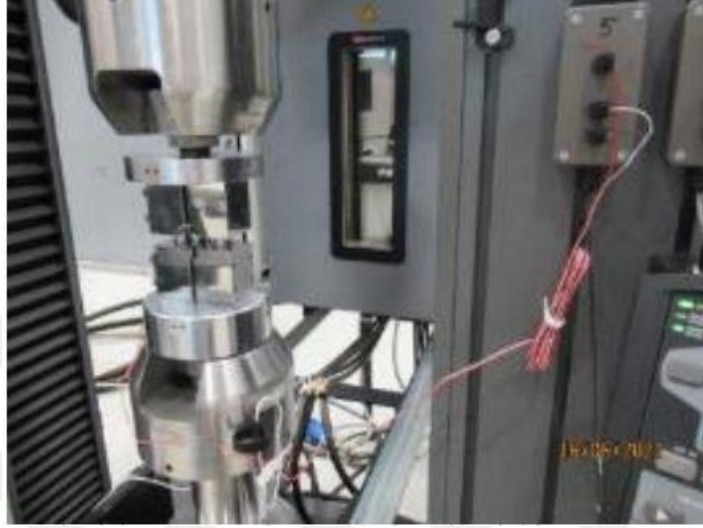
Şekil 3.33 Burkulma önleyici aparat ve basma yükü altındaki test numunesinin görüntüsü
