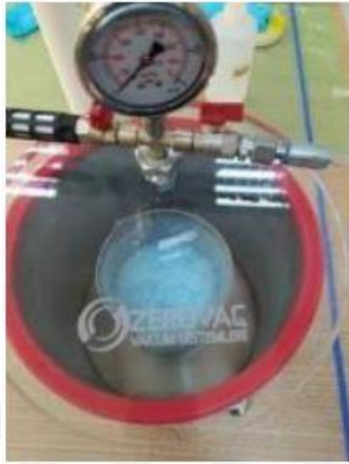
Şekil 3.25 Reçine sistemine uygulanan gaz alma işlemi
