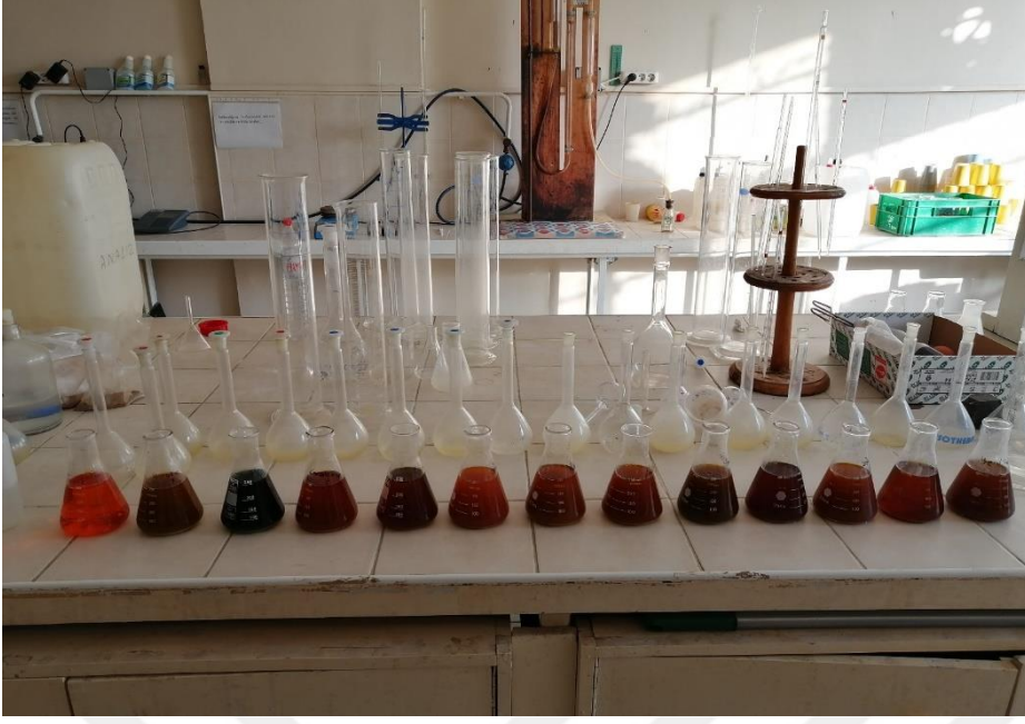
Şekil 3.10 Toprakların bazı fiziksel analizleri a)Saturasyon yöntemiyle pH ve EC analizi, b) Hidrometre yöntemiyle bünye tayini. c)Organik madde tayini.
