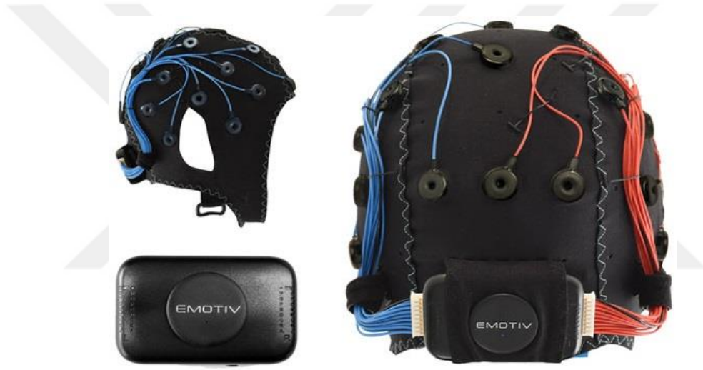
Şekil 2.37. EPOC Flex salin sensör kullanan EEG kayıt cihazı kiti
