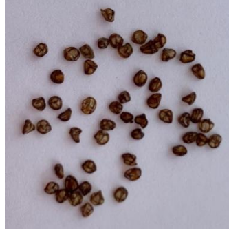
Şekil 3.15. (a) Alj-FeONP çözeltisinin damlatılmasında geniş çaplı pipet kullanımı sonrasında oluşan kuyruklu bilyelerin ıslak ve kuru hali, (b) kuyruklu bilyelerin \text{CaCl}_2 çözeltisinde düşük hızda karıştırılarak bekletildikten sonraki görüntüleri ve (c) vakum pompası kullanılarak kurutulan bilyelerin görüntüleri
