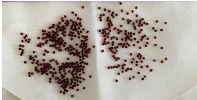
Şekil 2.8. (a) Tez çalışmasının üçüncü dönemindeki prosedüre göre elde edilen bilyelerin ve (b) yeni geliştirilen metot ile elde edilen bilyelerin gri suda 2 saatlik reaksiyonu sonrasındaki ıslak görünüşleri.
