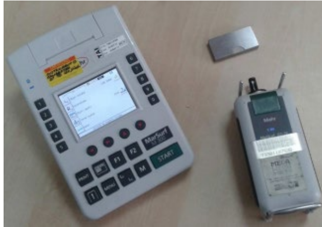
Şekil 3.16. Mahr MarSurfM300 model ölçüm cihazı.
