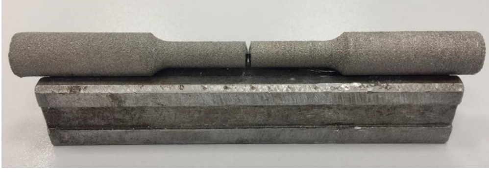
Şekil 3.9. Dairesel numunelerin kaynağında kullanılan yatak elemanı.
