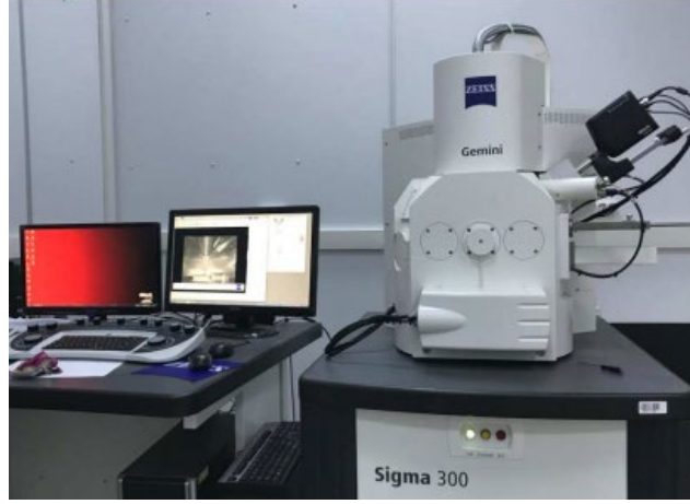
Şekil 3.15. ZEISS Sigma 300 taramalı elektron mikroskobu.
