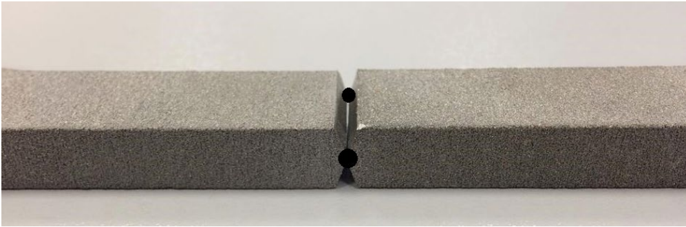
Şekil 3.8. Yassı numunelerin TIG kaynağı ile birbirine puntalanması.
