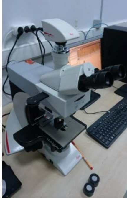
Şekil 3.12. Leica DM2700 M optik mikroskopi.
