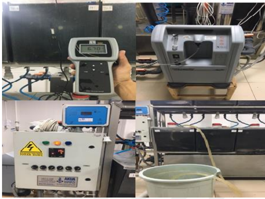
Şekil 9. Oksijen Jeneratörü, Oksijen-Sıcaklık Kontrolü ve Rutin Bakım
