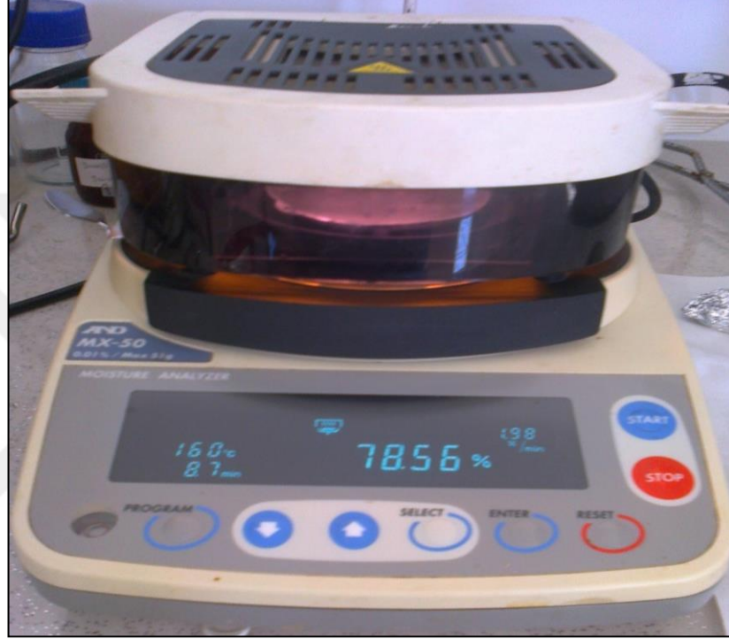
Şekil 3.2. Kupes balığının nem analizinde kullanılan cihaz (Özgün)
