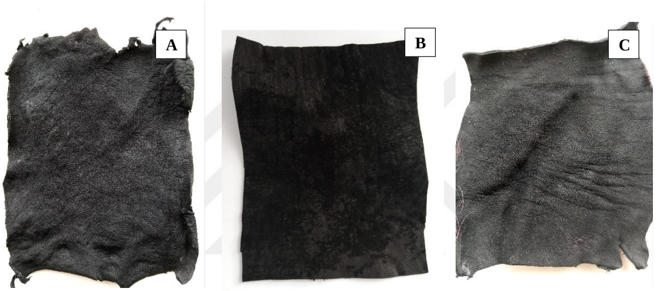
Şekil 39. Serbest Subtilisin Carlsberg (A), immobilize Subtilisin Carlsberg (B) ve geleneksel (kimyasal) yöntem (C) ile kıl giderimi sonrası diğer deri işleme süreçlerinden geçirilen deri yüzeyleri
