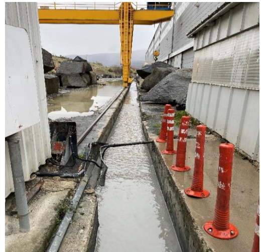
Şekil 2.4. Doğaltaşın Çamur Formunun Su Toplama Kanalları İle Taşınması
