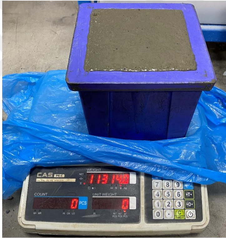
Şekil 3.14. Yaş Birim Hacim Ağırlığı Ölçüm İşlemi
