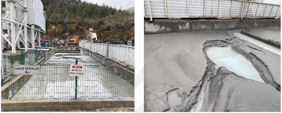
Şekil 2.5. Doğaltaş Atıklarının Çamur Halde Havuzda Bekletilmesi
