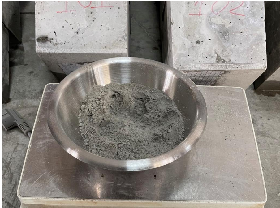
Şekil 3.8. Doğaltaş Atık Tozunun Kuru Formu
