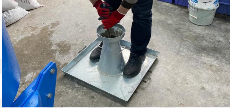
Şekil 3.9. Çökme (Slump) Hunisi Sabitleme
