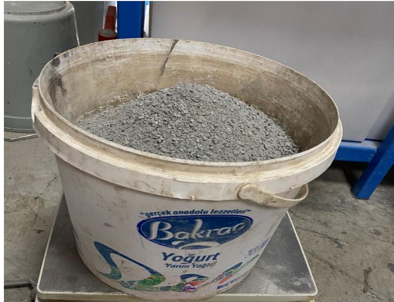
Şekil 3.2. 0-5 mm Agregada (kum)
