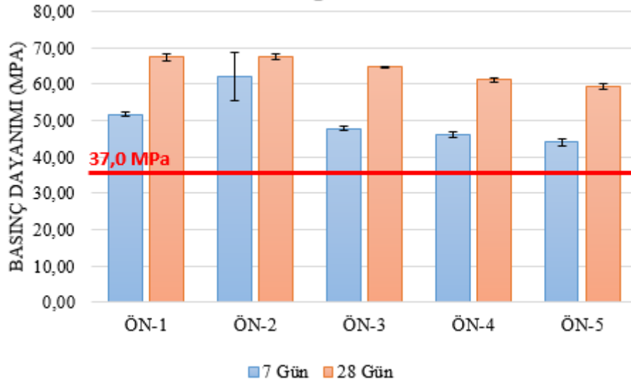
Şekil 3.16 Beton Numunelerinin Basınç Dayanım Sonuçları
