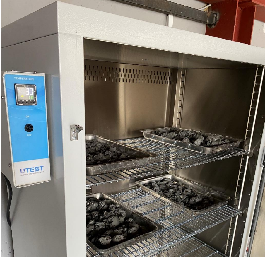
Şekil 3.7. Doğaltaş Atık Tozunun Etüvde Kurultması
