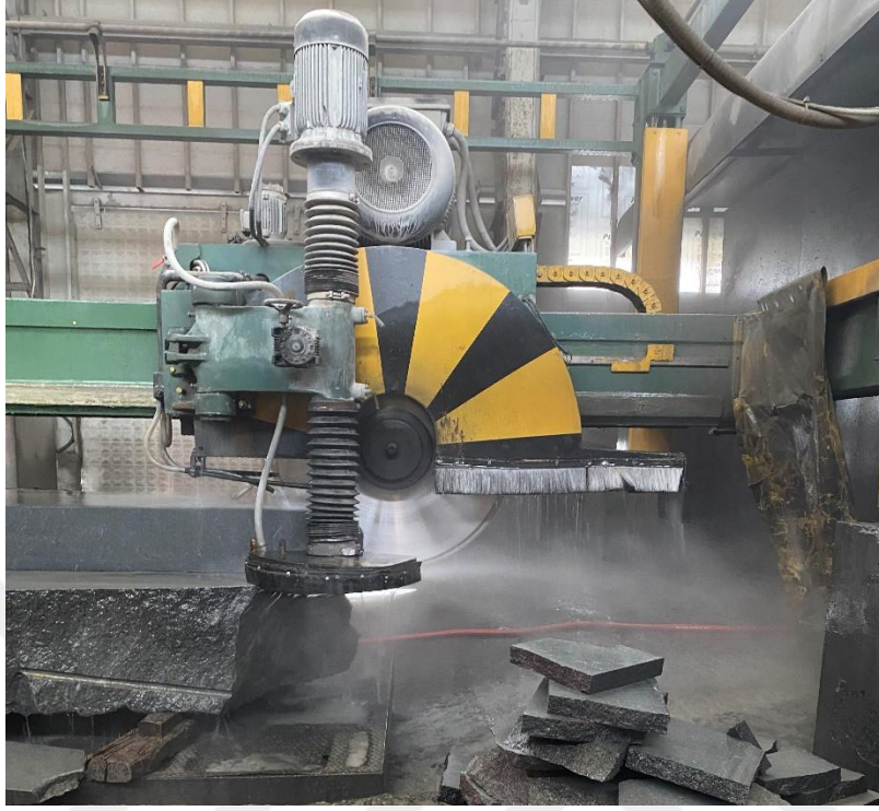
Şekil 2.3. Doğaltaşın Sulu Kesim İşlemi
