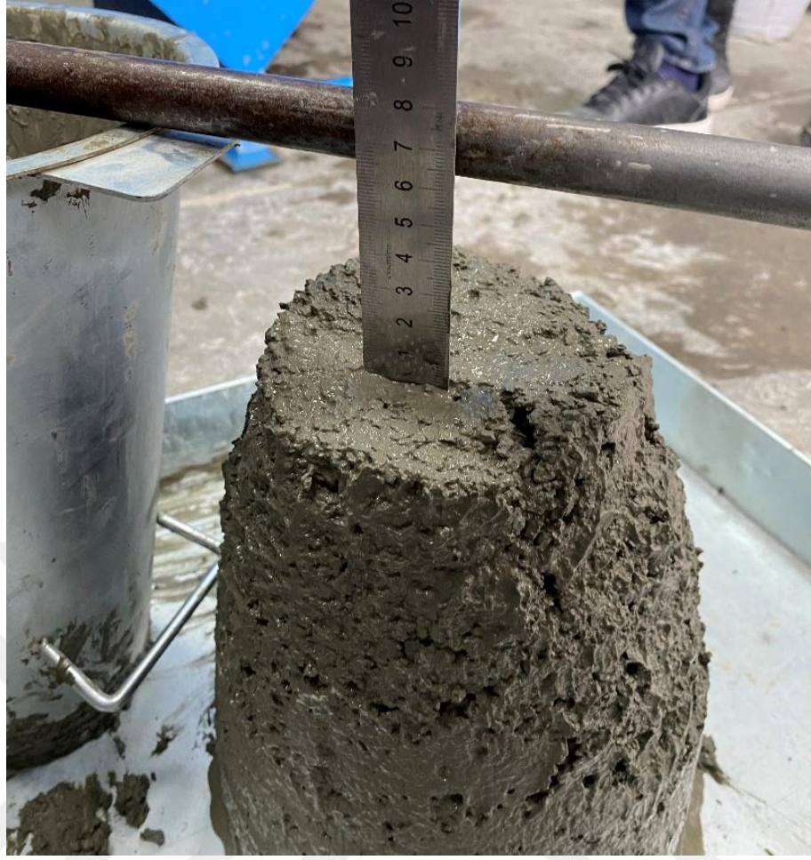
Şekil 3.10. Çökme (Slump) Değer Ölçümü
