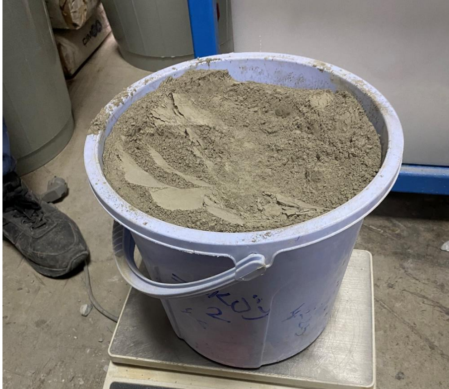
Şekil 3.5. CEM I 42.5 R Tipi Çimento
