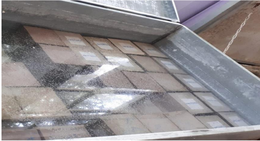
Şekil 3.15 Beton Kürleme Metodu Görüntüsü
