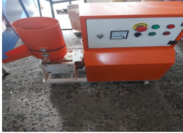
Şekil 3.6. Çalışmada kullanılan 3 kw'lık pelet makinası
