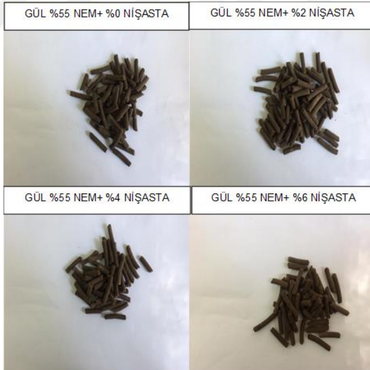
Şekil 3.14. % 55 nem ve farklı bağlayıcı oranları kullanılarak hazırlanan gül peletleri
