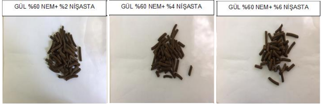
Şekil 3.15. % 60 nem ve farklı bağlayıcı oranları kullanılarak hazırlanan gül peletleri
