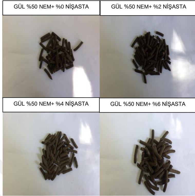
Şekil 3.13. % 50 nem ve farklı bağlayıcı oranları kullanılarak hazırlanan gül peletleri
