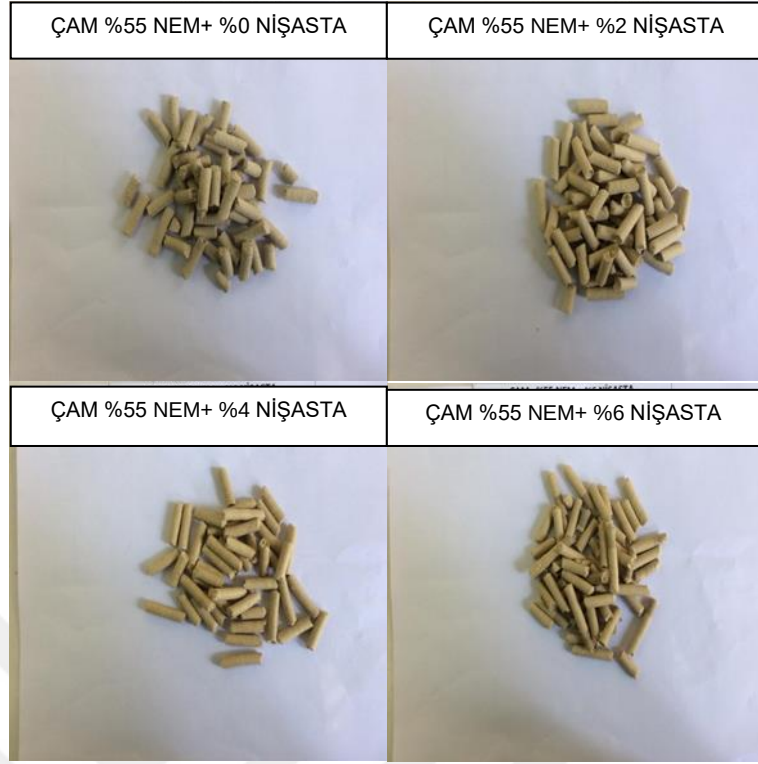
Şekil 3.11. % 55 nem ve farklı bağlayıcı oranları kullanılarak hazırlanan çam peletleri
