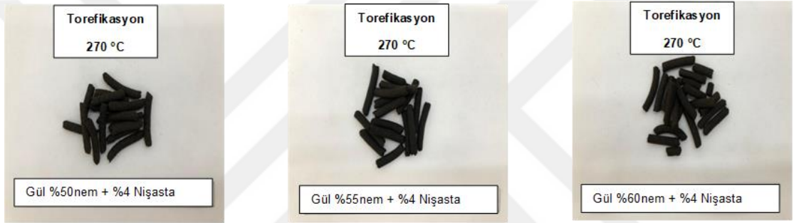
Şekil 3.9. %50, %55 ve %60 nem oranlarında torefiye edilen gül peletleri
