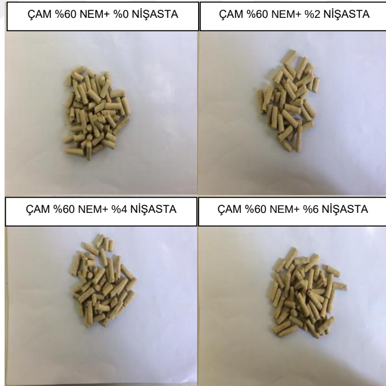
Şekil 3.12. % 60 nem ve farklı bağlayıcı oranları kullanılarak hazırlanan çam peletleri
