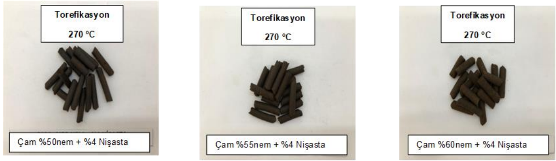
Şekil 3.8. %50 - %55 - %60 nem oranlarında torefiye edilen çam peletleri
