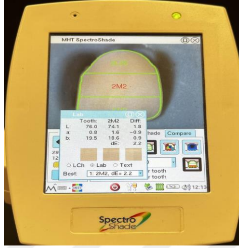
Şekil 3.20. SS ile L, a* ve b* değerlerinin ölçümünün yapılması
