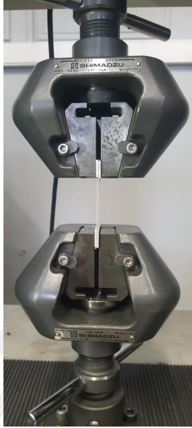
Şekil 3.10: Çekme deneyi yapılan membran numunesine ait görsel.
