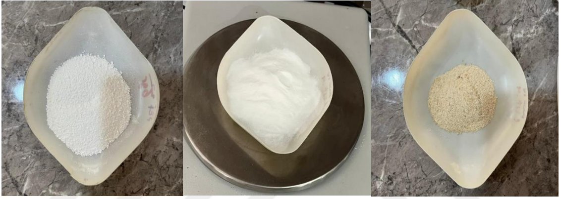
Şekil 3.1: Membran üretiminde kullanılan malzemelerin görünümü: (a) PES, (b) PVP, (c) CNF.
