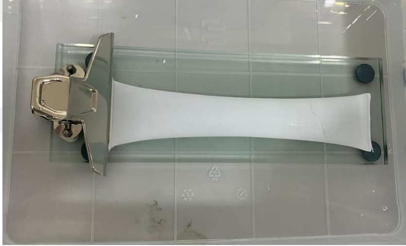
Şekil 3.5: Su banyosunda faz inversiyon yöntemiyle üretilen membran.
