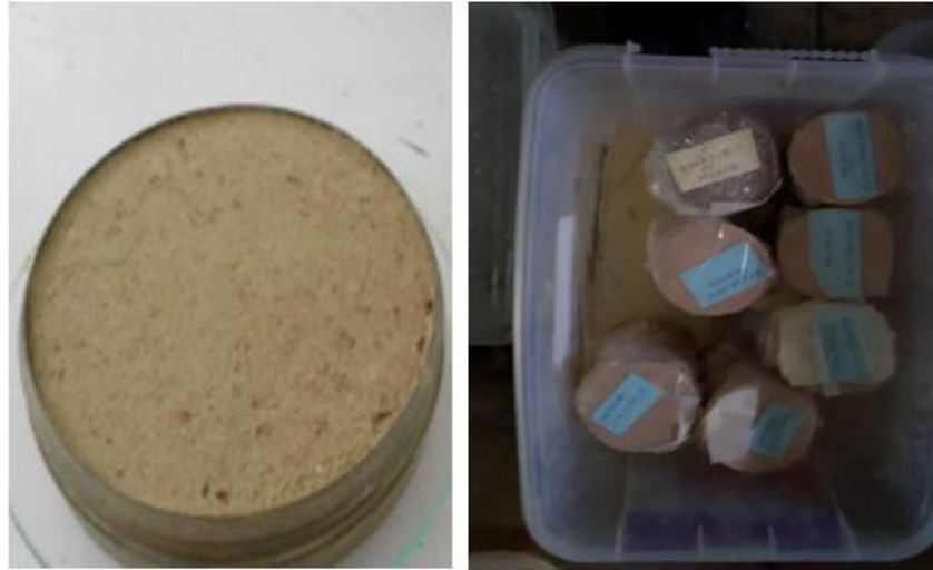
Şekil 3.17 Dairesel kesici içerisinde sıkıştırılmış numune örneği ve streç film ile sarılarak etiketlenen kür odasında bekletilmek üzere hazırlanan dairesel en kesitli direkt kesme kutusu deneyi numuneleri
