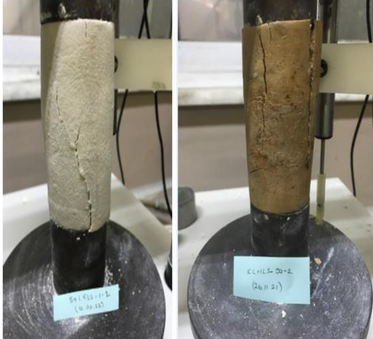
Şekil 3.16 Kür odasında 1 gün bekletilmiş %1,5 linyosülfonat içeren S+1.5LS-1 ve kür odasında 90 gün bekletilen ve %1 linyosülfonat içeren KL+1LS-90 numunelerinin kırılması
