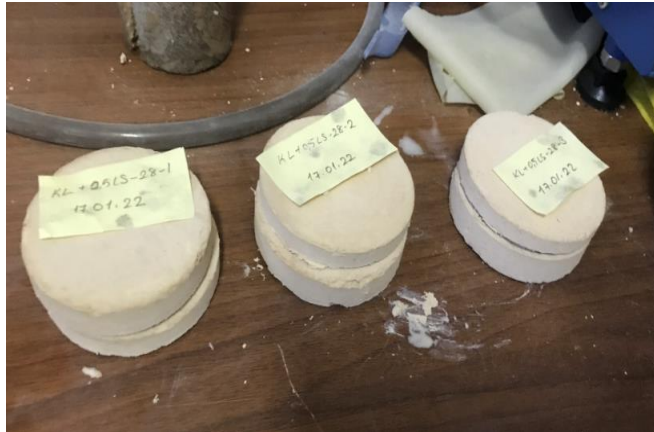
Şekil 4.66 Farklı normal basınçlar uygulanan %0,5 linyosülfonat katkılı kaolin zeminlerin kesme kutusu deneyi numuneleri
