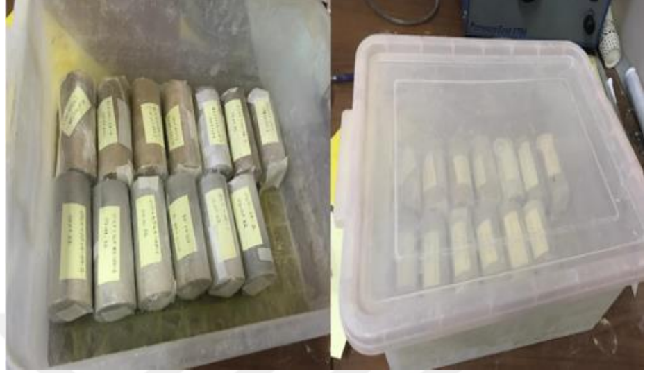
Şekil 3.15 28 günlük kürde bekletilmek üzere streç filme sarılarak ağzı kapalı bir kaptaki bekletilen serbest basınç deneyi numuneleri
