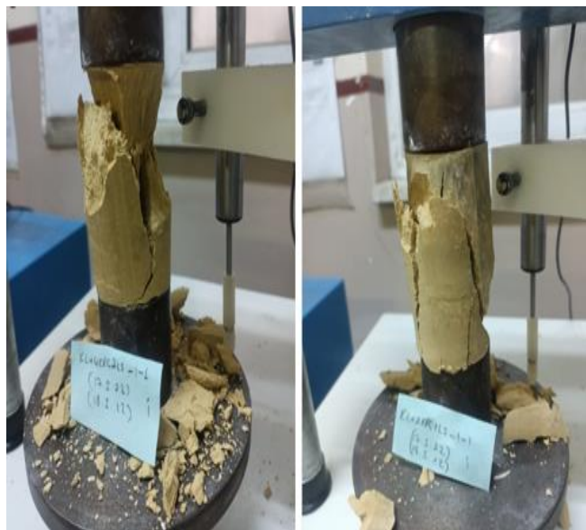
Şekil 3.20 1 günlük kürde bekletilmiş KL+4KRÇ2LS-1 ve KL+2KRÇ1LS-1 numuneleri
