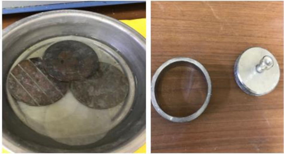
Şekil 3.10 Çıkıntılı metal plaka, poroz taşlar, dairesel kesici ve üst başlık
