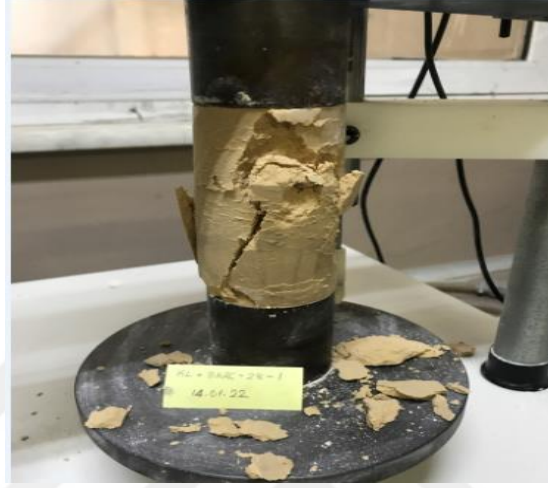
Şekil 3.18 28 gün kürde bekletilen ve %3 kireç içeren KL+3KRÇ-28 numunesi
