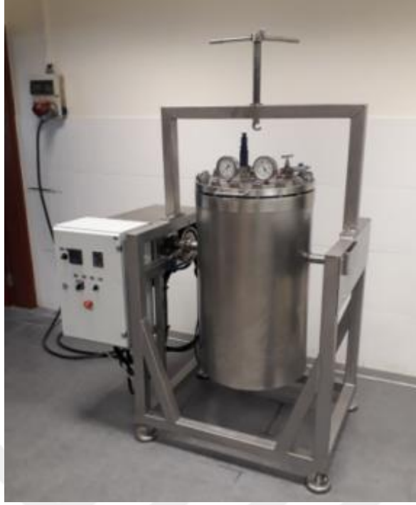
Şekil 5. Elektrik ısıtıcılı döner pişirme kazanı
