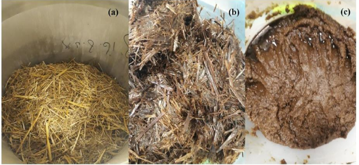
Şekil 13. İki (2) nolu pişirmeye ait görseller: buğday samanı pişirme öncesi (a), pişirme sonrası (b) ve rafinörde öğütüldükten sonraki görünümü (c)
