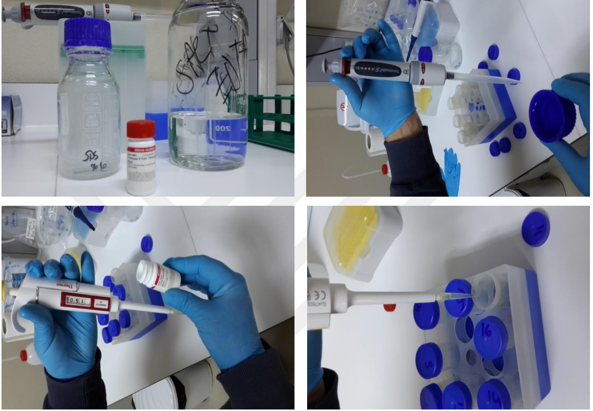
Şekil 3.21. Falkon tüplere tuz/EDTA, SDS, proteinaz K ilave edilmesi
