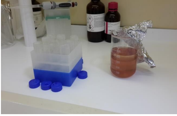
Şekil 3.22. Tüplere fenol ilave edilmesi ve süpernatant kısmın alınması
