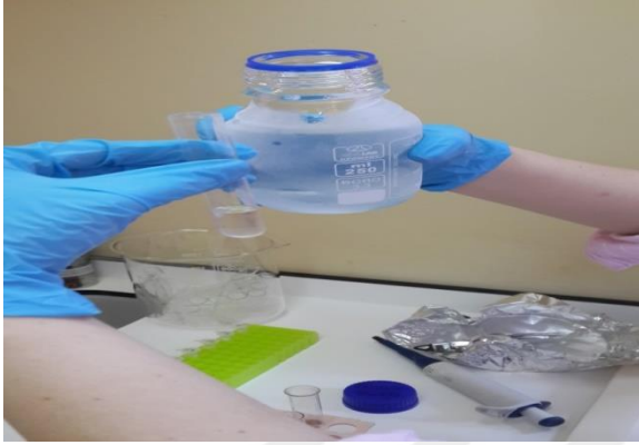
Şekil 3.23. Cam tüplere fenol: kloroform: isoamil alkol ilavesi ve DNA görünürlüğü
