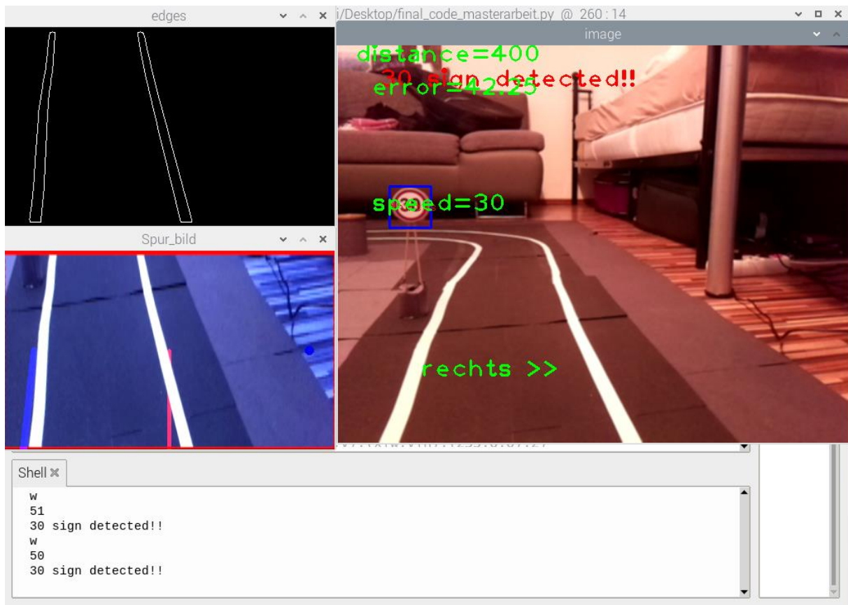
Abbildung 36 : Erhalten des w-Wertes für 60cm Entfernung
