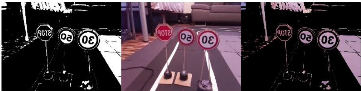
Abbildung 42 : weiße Maske für Objekterkennung
