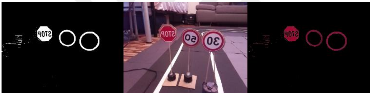
Abbildung 41 : Rote Maske für Objekterkennung
