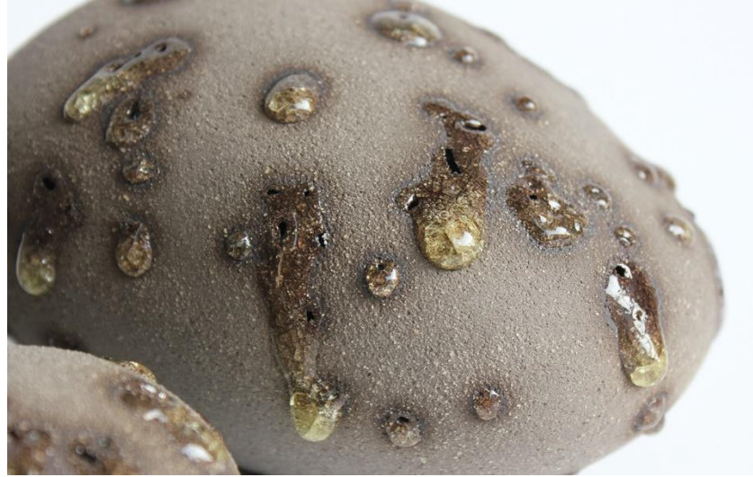
Şekil 66- Renkli frit katkılı stoneware bünye detayı (Fadliye Yılmaz, 2022)
