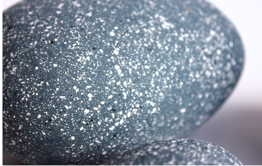
Şekil 62- Renk veren oksit ve molokit katkılı stoneware bünye detayı (Fadliye Yılmaz, 2022)
