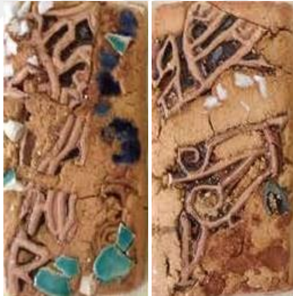
Şekil 21- Mine Poyraz, Ajurlu seramik ve seramik atık (porselen, seramik, krem ve kahverengi karo) katkılı şamotlu bünye, Artistik Kaplama Uygulamaları , 950-1000 °C, 2018 (Poyraz, 2018: 24)
