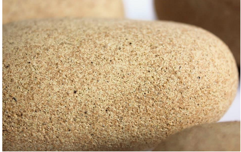
Şekil 68- Odun külü katkılı stoneware bünye detayı (Fadliye Yılmaz, 2022)
