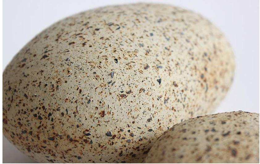
Şekil 74- Atık metal katkılı stoneware bünye detayı (Fadliye Yılmaz, 2022)
