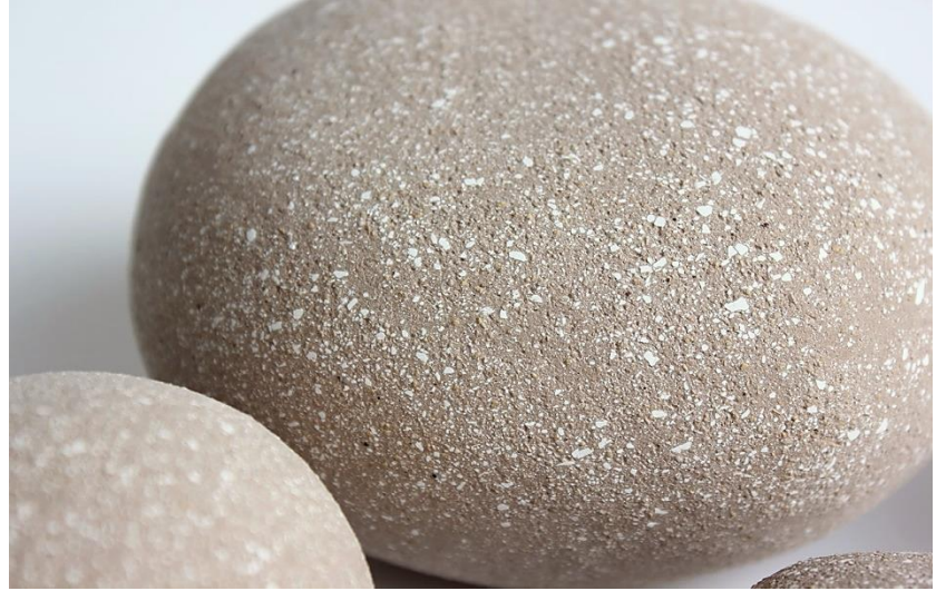
Şekil 64- Molokit katkılı stoneware bünye detayı (Fadliye Yılmaz, 2022)
