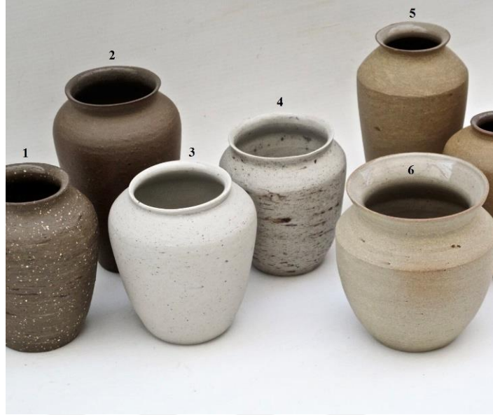
Şekil 5- Bisila Noha, 1- Molokit katkılı porselen ve Baney kili 9 karşımı bünye 2- %75 Porselen ve %25 Baney kili karşımı bünye 3- %90 Porselen ve %10 Baney kili karşımı bünye 4- %90 şamotlu porselen ve %10 Baney kili karşımı bünye 5- %75 stoneware ve %25 Baney kili karşımı bünye 6- %90 Stoneware ve %10 Baney kili karşımı bünye, Baney Pieces , 2020 (Noha, 2020)
