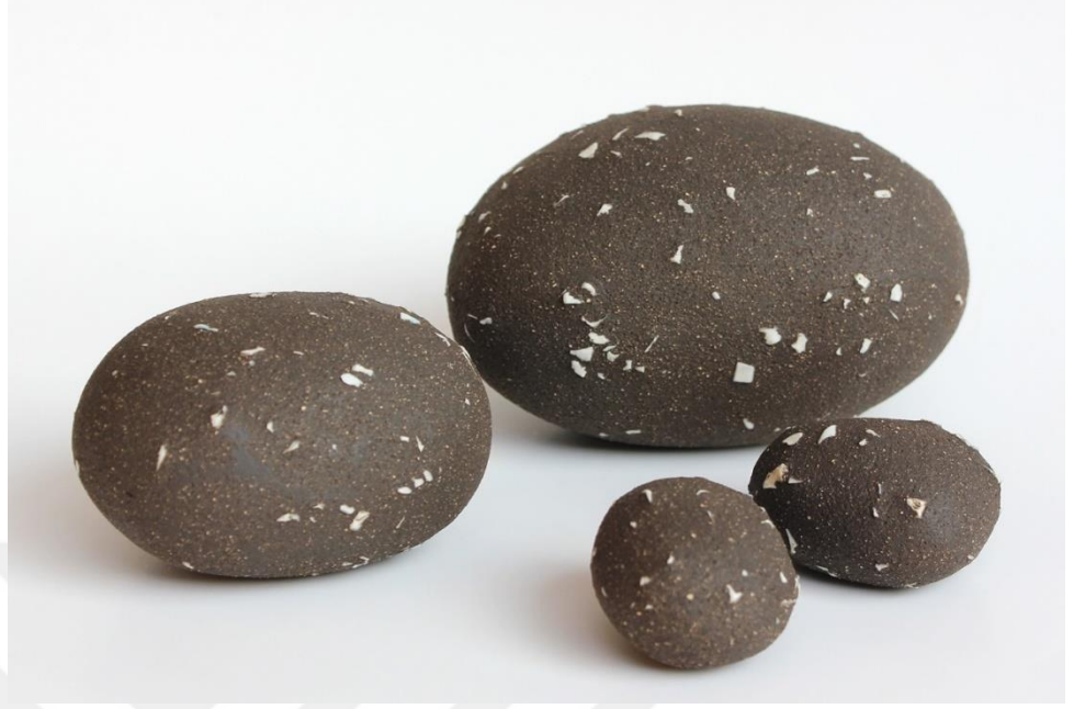
Şekil 71- Atık sırlı porselen katkılı stoneware bünye (Reçete AP), Taşlar , 7,5x17x17 cm, 1200 °C, 2022 (Fadliye Yılmaz, 2022)
