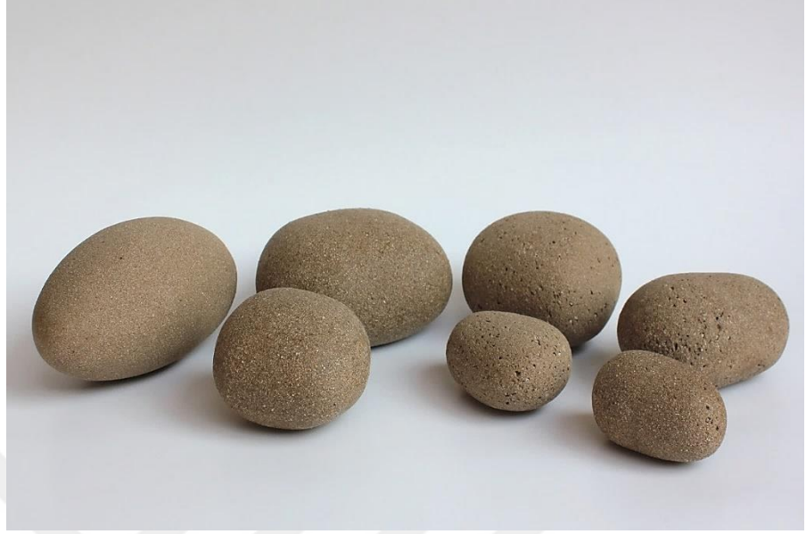
Şekil 59- Soldan Sağa: 1- Kuvars katkılı stoneware bünye (Reçete KU) 2- Kuvars ve mika katkılı stoneware bünye (Reçete KUMİ) 3- Kuvars ve perlit katkılı stoneware bünye (Reçete KUPE) 4- Kuvars, mika ve perlit katkılı stoneware bünye (Reçete KMP), Taşlar, 7x40x20 cm, 1200 °C, 2022 (Fadliye Yılmaz, 2022)
