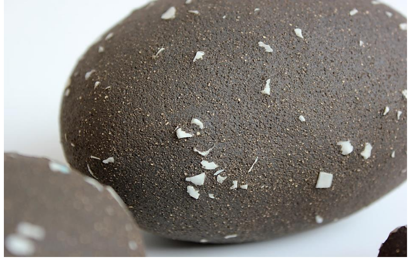
Şekil 72- Atık sırlı porselen katkılı stoneware bünye detayı (Fadliye Yılmaz, 2022)
