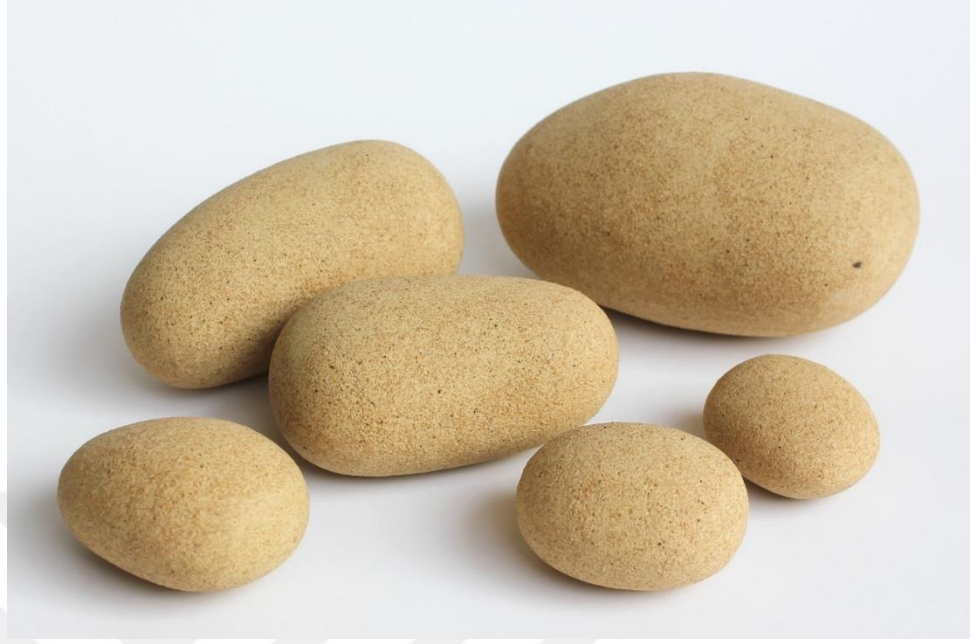
Şekil 67- Odun külü katkılı stoneware bünye (Reçete OK), Taşlar , 5,5x25x18 cm, 1200 °C, 2022 (Fadliye Yılmaz, 2022)
