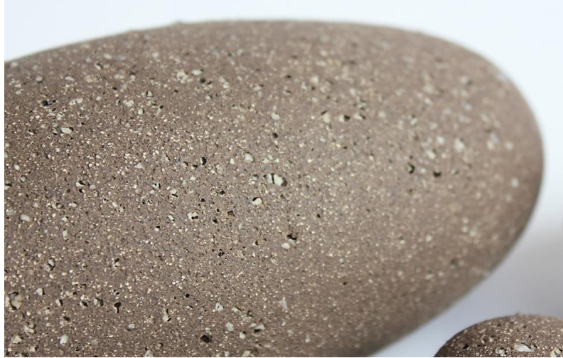
Şekil 56- Perlit katkılı stoneware bünye detayı (Fadliye Yılmaz, 2022)
