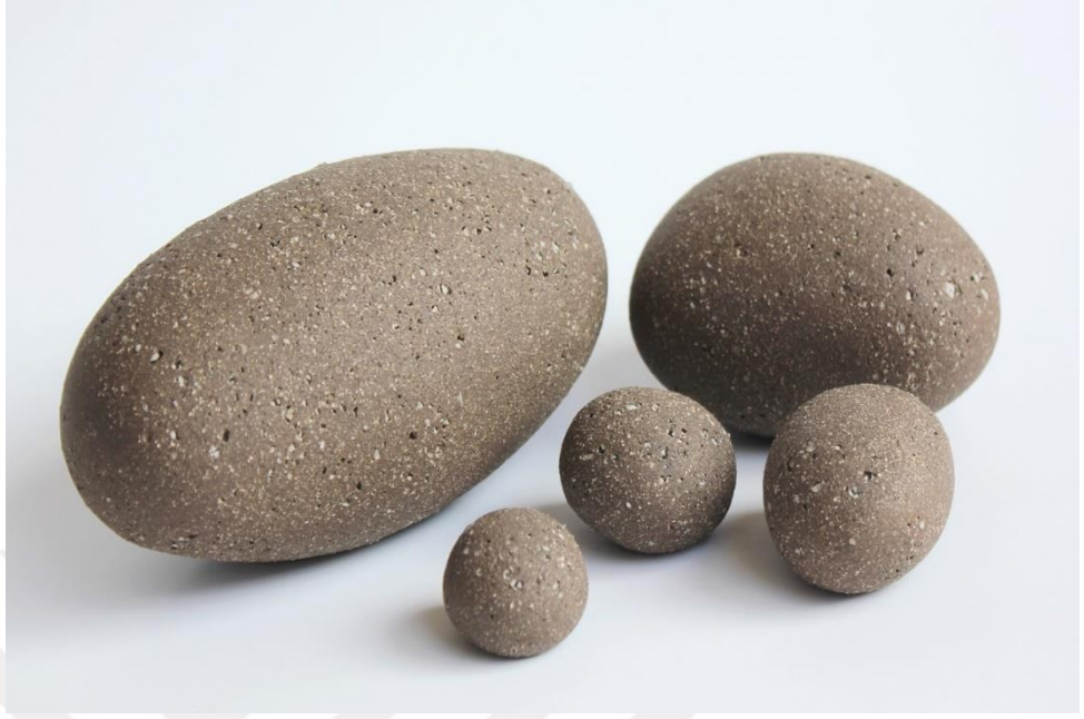
Şekil 55- Perlit katkılı stoneware bünye (Reçete PE), Taşlar , 7x22x15 cm, 1200 °C, 2022 (Fadliye Yılmaz, 2022)
