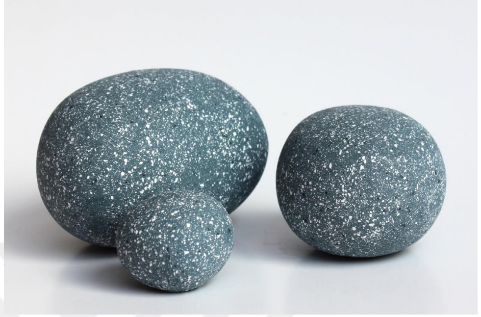
Şekil 61- Renk veren oksit ve molokit katkılı stoneware bünye (Reçete KOMO), Taşlar , 7x18,5x14 cm, 1200 °C, 2022 (Fadliye Yılmaz, 2022)
