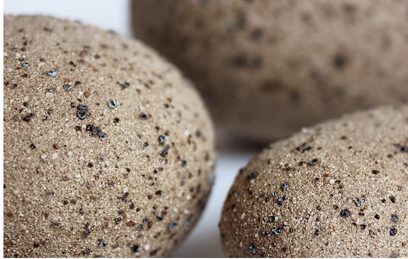
Şekil 58- Kuvars kumu ve deniz kumu katkılı stoneware bünye detayı (Fadliye Yılmaz, 2022)
