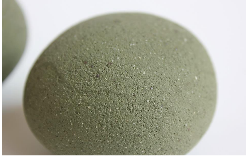
Şekil 70- Seramik boyası ve kuvars kumu katkılı stoneware bünye detayı (Fadliye Yılmaz, 2022)
