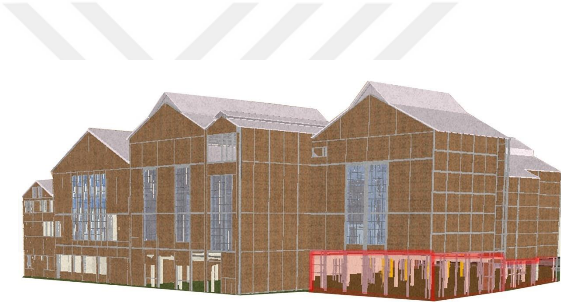
Şekil 5. 7. Elektrik fabrikasının batı cephesindeki bloğun zemin katının duvarlarının boşaltılmasının görselleştirilmesi
