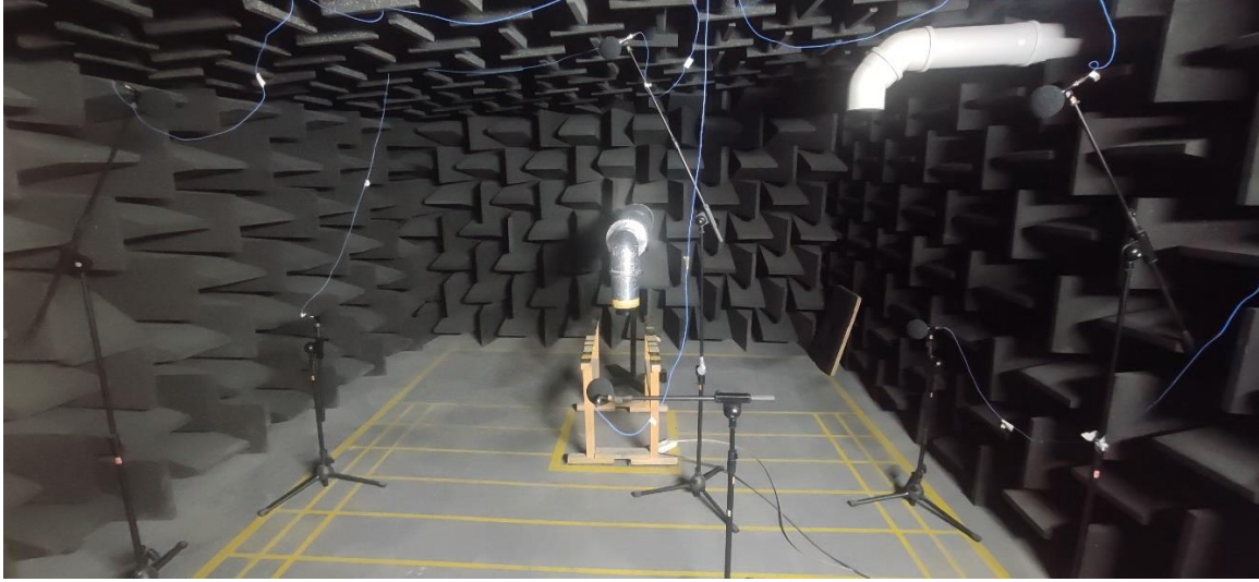
Resim 3.3. Yarı çınlamalı deney odası
