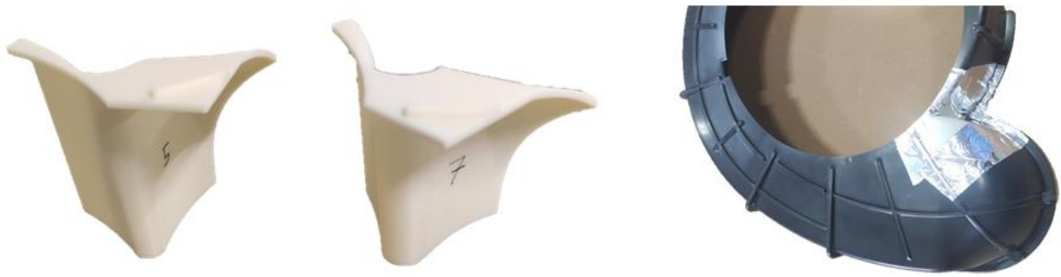
Resim 4.7. 3B parçaların salyangoza montajı
