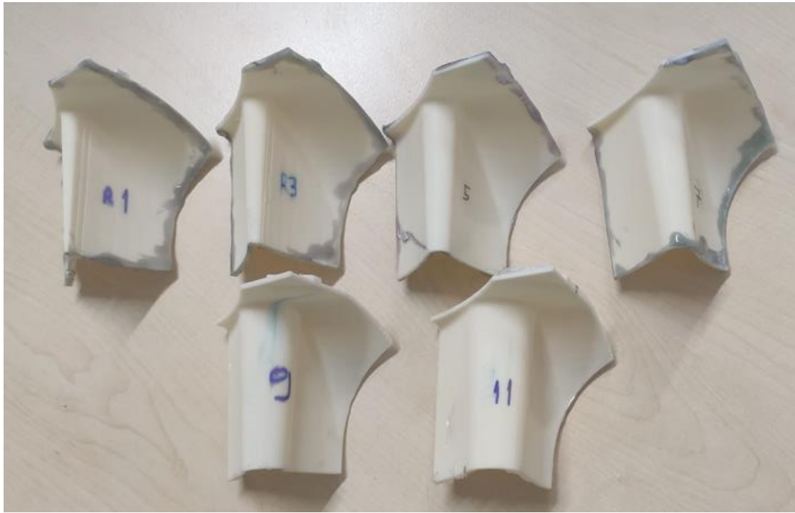
Resim 3.7. 3B kıvrımlı dil numuneleri
