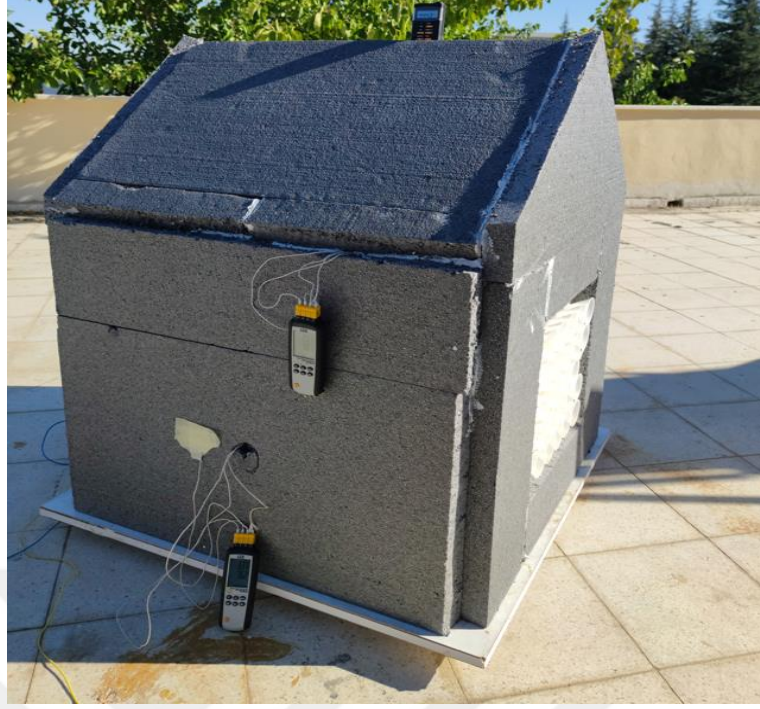
Şekil 2.10. EPS ısı yalıtım malzemesiyle kaplı bina görüntüsü
