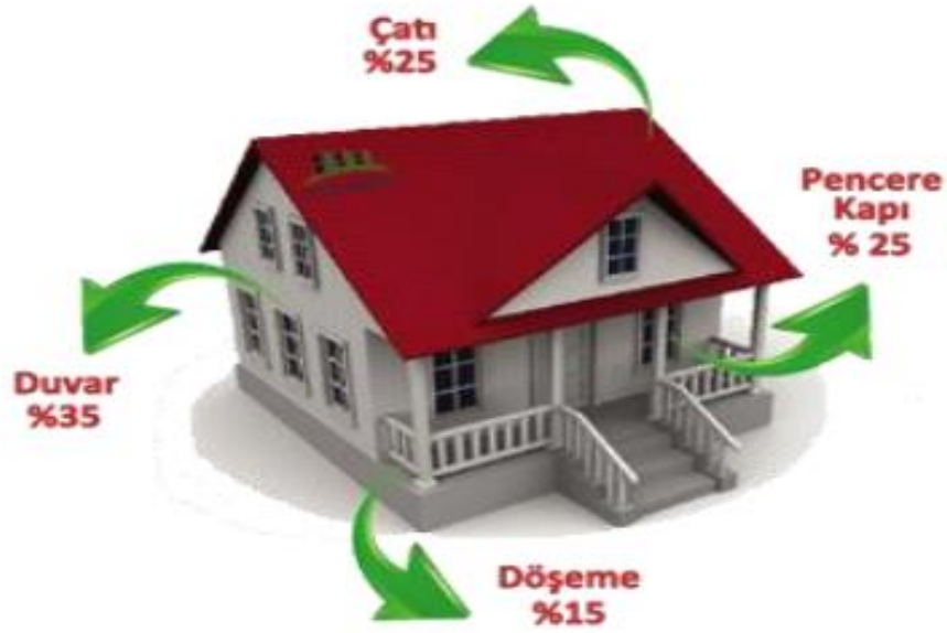
Şekil 1.6. Binalarda gerçekleşen ısı kayıpları [10].
