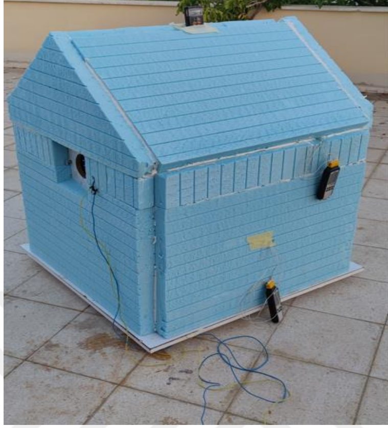
Şekil 2.12. XPS ısı yalıtım malzemesiyle kaplı bina görüntüsü
