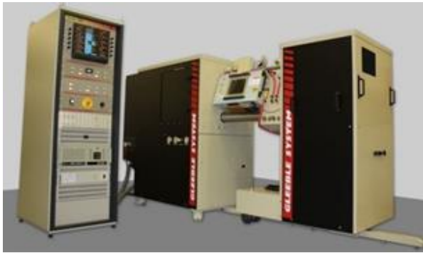
Resim 3.6. Gleeble 3800 termomekanik test cihazı
