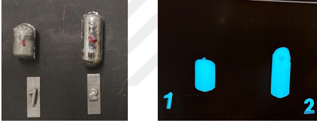
Resim 4.36. Ti-43Al-6Hf-2Nb alařımlarının radyografik muayene görüntüleri
