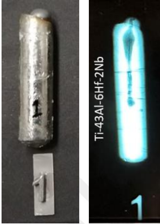
Resim 4.34. Ti-43Al-6Hf-2Nb alaşımlarının radyografik görüntüleri
