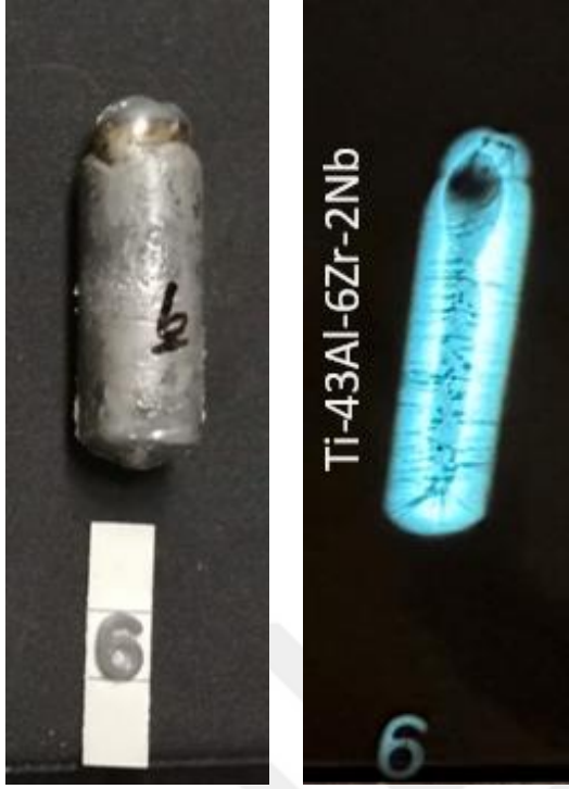
Resim 4.30. Ti-43Al-6Zr-2Nb alařımının radyografik g r nt leri
