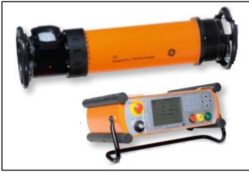
Resim 3.9. Radyografik muayene ekipmanları
