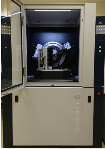
Resim 3.4. Bruker Advance 8 kırınım ölçer cihazı
