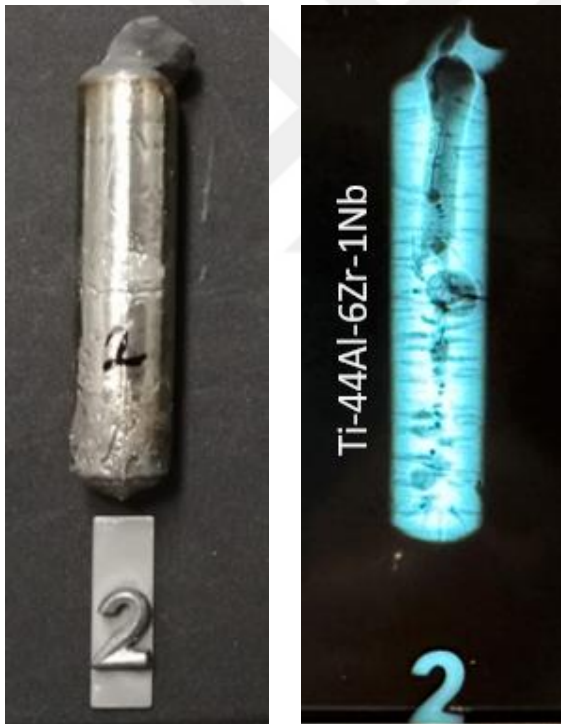
Resim 4.28. Ti-44Al-6Zr-1Nb alaşımının radyografik görüntüleri
