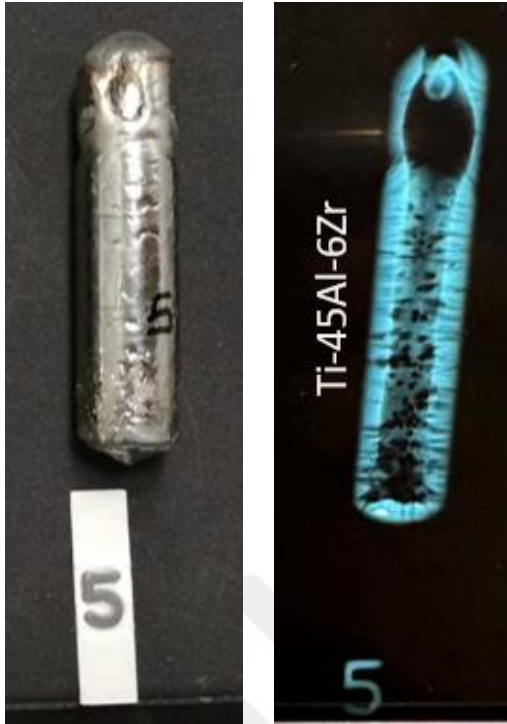
Resim 4.26. Ti-45Al-6Zr alařımının radyografik görüntüleri
