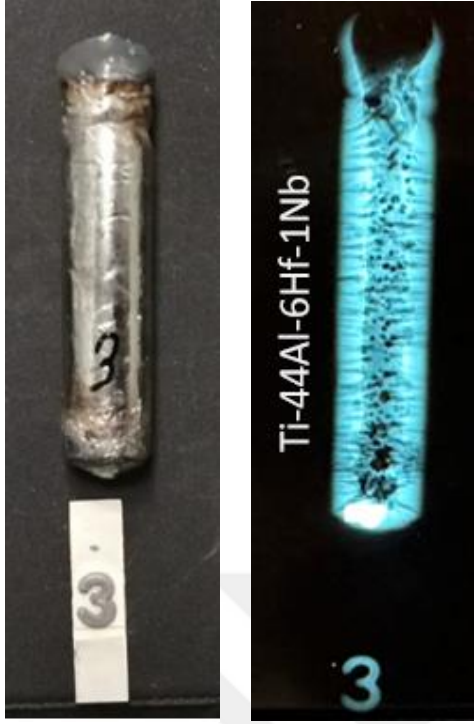
Resim 4.32. Ti-44Al-6Hf-1Nb alaşımının radyografik görüntüleri
