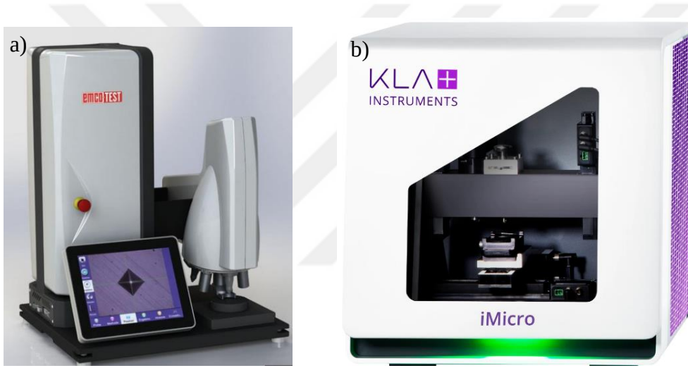
Resim 3.7. a) EmcoTest durascan 20 mikrosertlik cihazı b) KLA instruments iMicro nanoindentasyon cihazı
