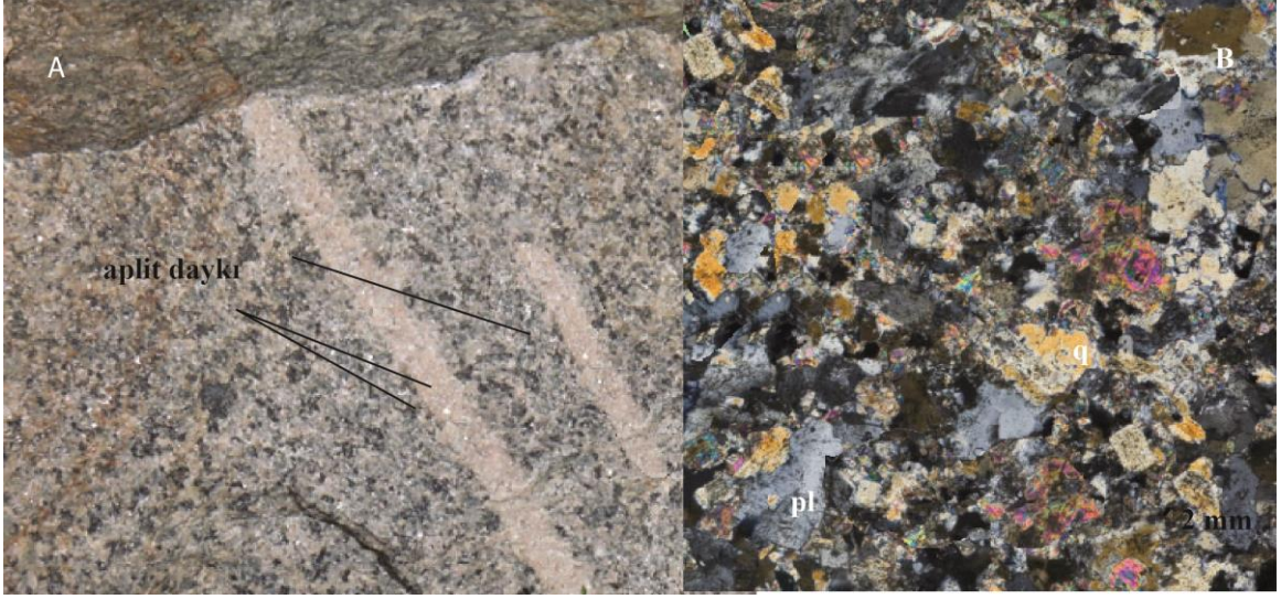
ŞEKİL 3.8. Aplit Daykından Alınmış El Örneđi (A) Ve İnce Kesit Görüntüsü (B).
