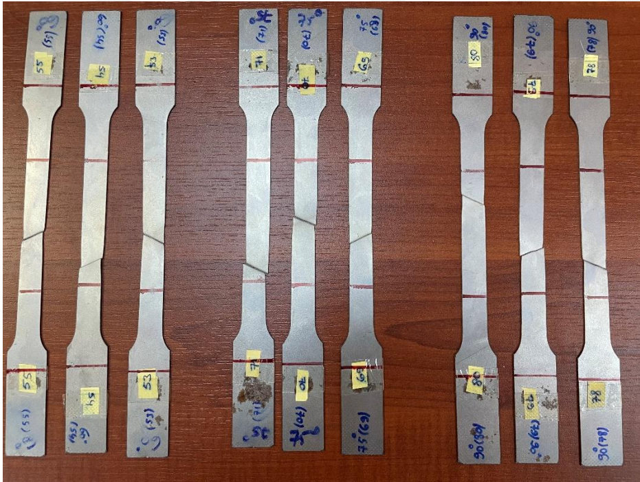
Şekil D.4. 60°, 75° ve 90° açılı doğrultularda kesilen DP600 test numunelerinin çekme testi sonrası kırılmış görüntüsü.
