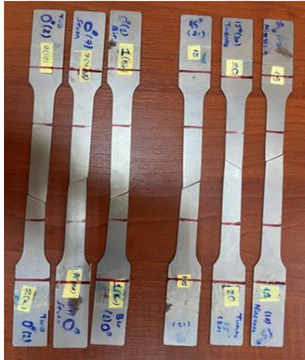
Şekil D.2. 0° ve 15° açılı doğrultularda kesilen DP600 test numunelerinin çekme testi sonrası kırılmış görüntüsü.
