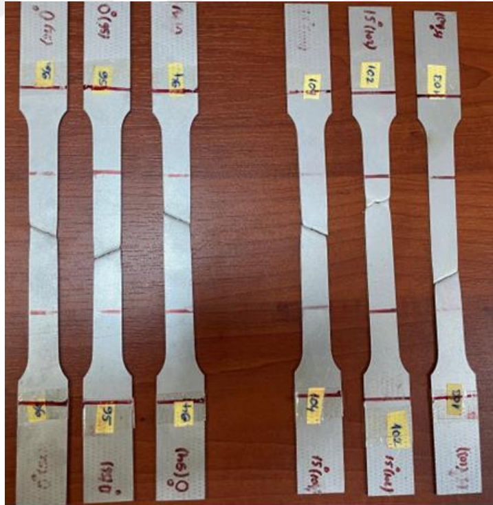
Şekil D.6. 0° ve 15° açılı doğrultularda kesilen DP800 test numunelerinin çekme testi sonrası kırılmış görüntüsü.
