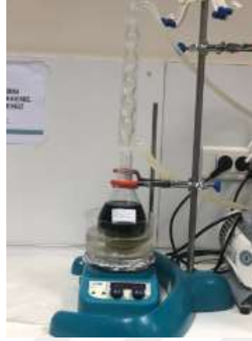
Şekil 7. Aydın-Çine’ye ait zeytin yaprağı 40 °C’de ekstraksiyon görüntüsü
