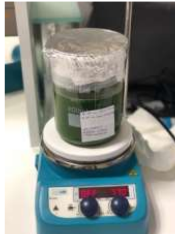
Şekil 8. Balıkesir-Edremit’e ait zeytin yaprağı 20 °C’de ekstraksiyon görüntüsü
