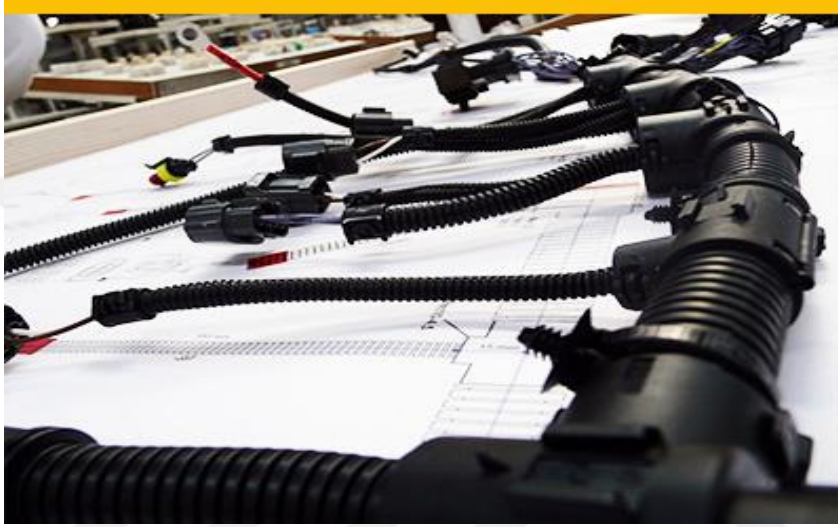
Şekil 1.7: Hazırlanmış Kablo Demeti (Tesisat) Örneği
