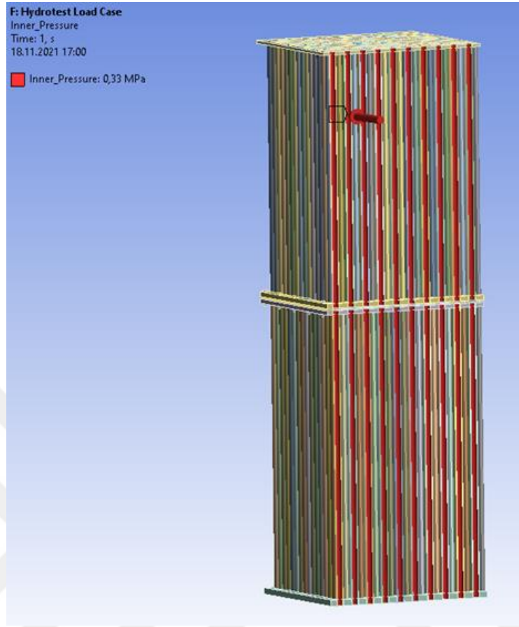
řekil 4.33. Yk Durumu 03 Hidro-Test Basıncı
