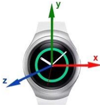
Şekil 1.5. Akıllı Saat İvmeölçer Algılayıcısı Eksenleri (Sağbaş 2016)
