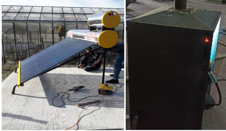
Şekil 3.17. Güneş enerji sistemi ve kabin kurutucunun imalatı ve montajı
