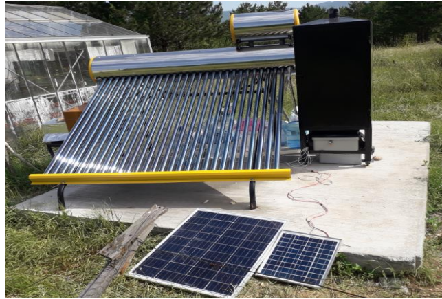
Şekil 3.1. Vakum tüplü güneş enerjili kabin tipi kurutma sistemi
