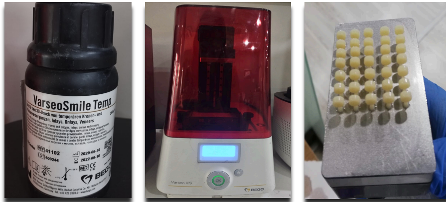
Şekil 13. 3D Varseo XS Cihazı, Reçine Materyali ve Üretim Sonrası Görüntü
