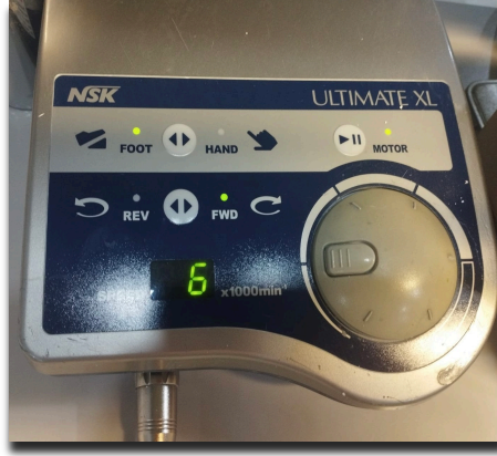
Şekil 21. Mekanik Polisajda NSK ULTIMATE XL Cihazı ve 6.000 Devir Göstergesi
