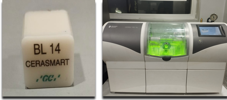
Şekil 17. GC Cerasmart Bloğu ve Dentsply Sirona Cerec MCXL CAD/CAM Cihazı
