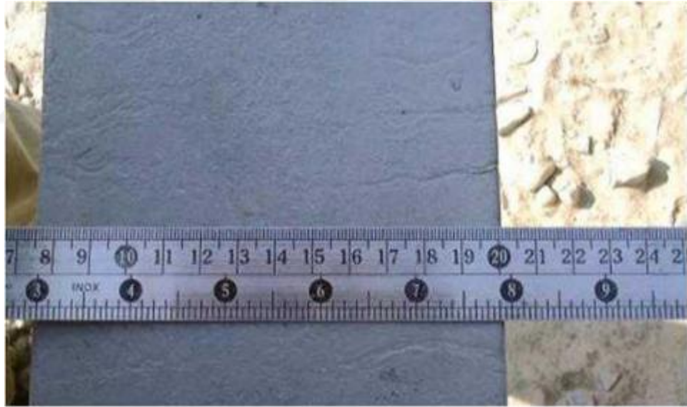
Şekil 2.13. Kum püskürtülmüş kütük üzerindeki enine çatlağın görünümü [3].
