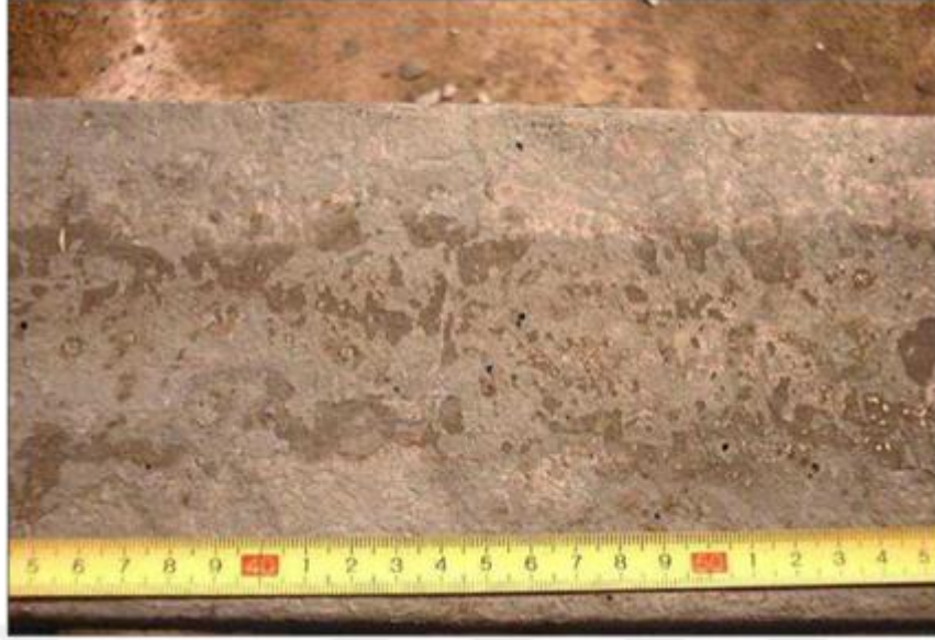
Şekil 2.6. Yeniden ısıtılmış ve haddelenmemiş 150 x 150 mm orta karbon kütüğün yüzeyinde kalan iğne deliklerinin görünümü [2,3].
