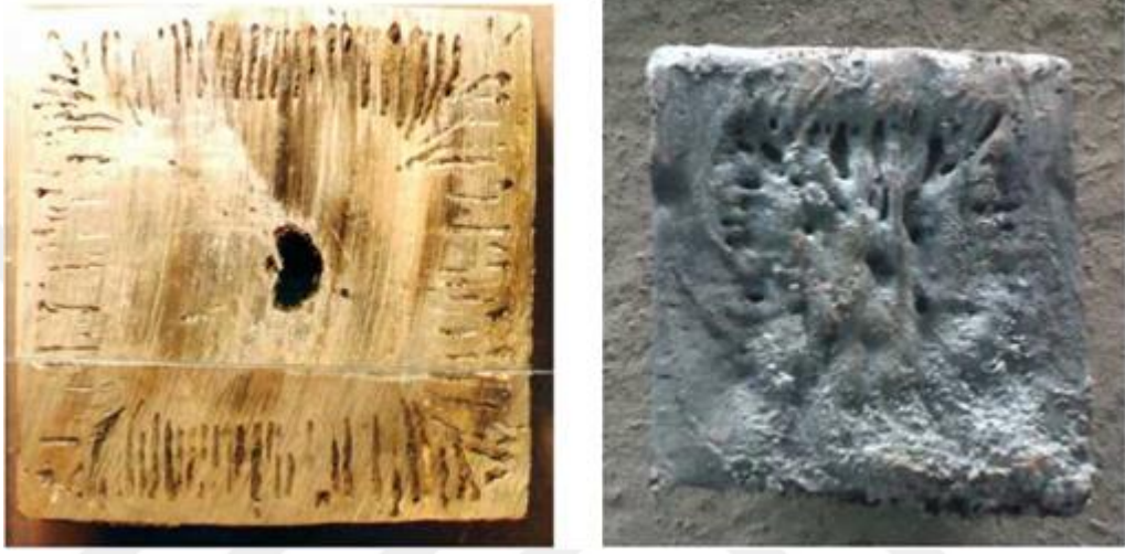
Şekil 2.20. Sol: Hava delikli bir karbon çelik kütüğün sulu kesme diskisi ile kesimi [1,2]. Sağda: Hava delikleri olan bir karbon çelik kütüğün oksijenle kesilmesi.
