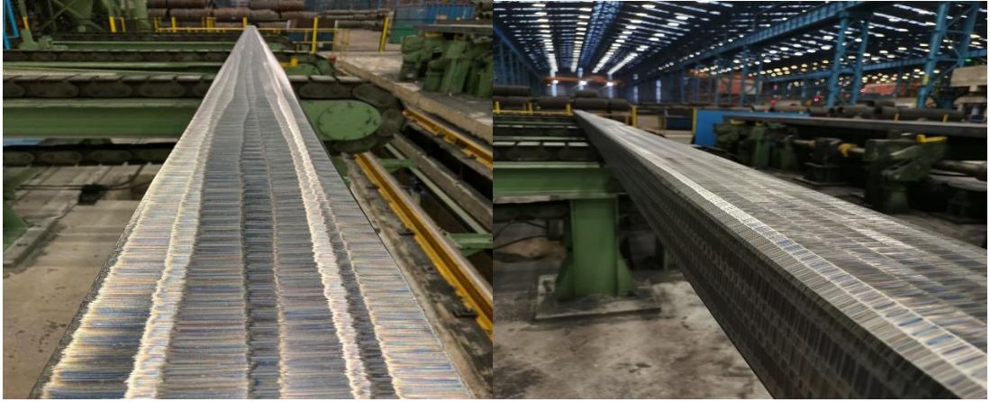
Şekil 4.6. Taşlanmış Yarı Mamül Kütüğün Görseli
