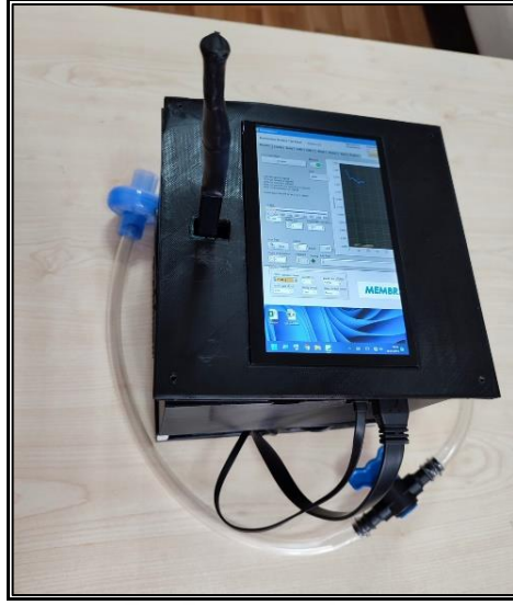
Şekil 3.7. Nefes analiz teşhis sistemi
