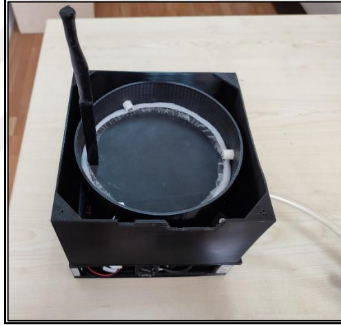
Şekil 3.8. Nefes analiz sistemi soğurma hücresi
