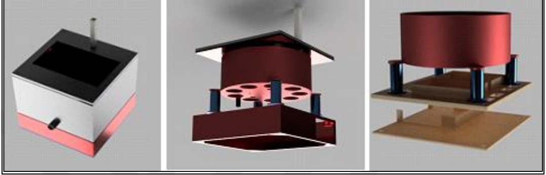
Şekil 3.1. a) Nefes analiz sisteminin dış görünüm b) sensör yerleşim yerleri görülen iç katman c) Kart yerleşim yerleri görülen iç katman
