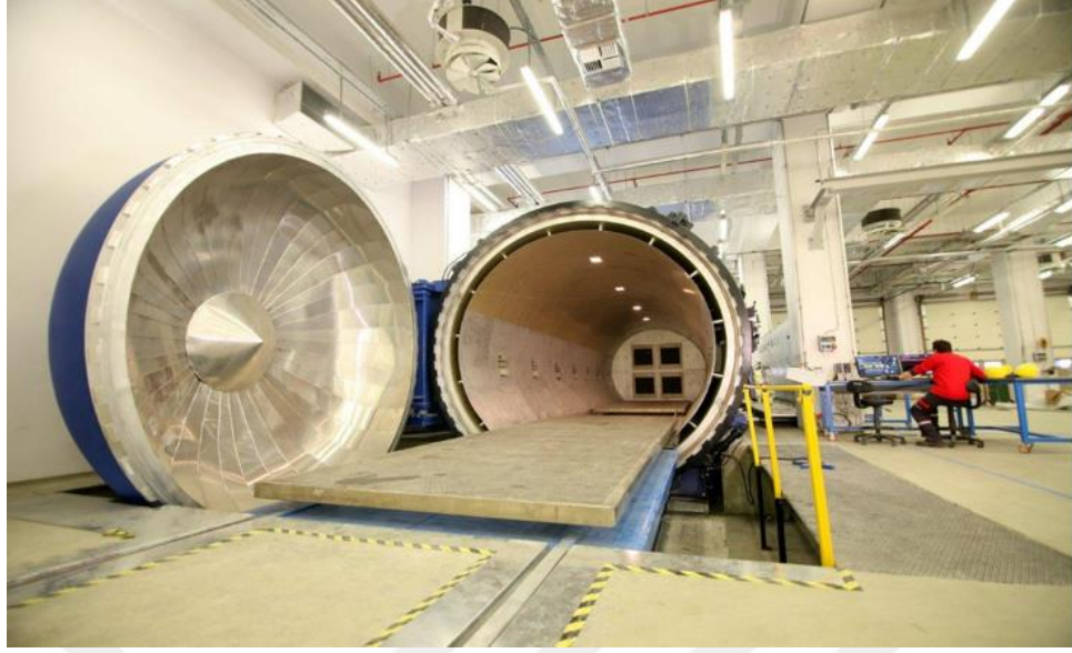
Şekil 3.8. Otoklav yönteminin uygulandığı sistem
