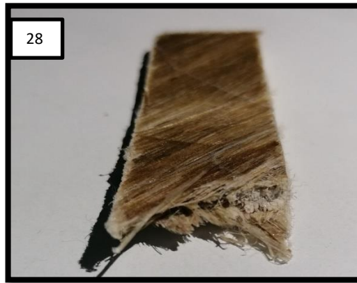
Şekil 8.12. Darbe testi uygulanmış numunelerin kırık yüzey görüntüleri
