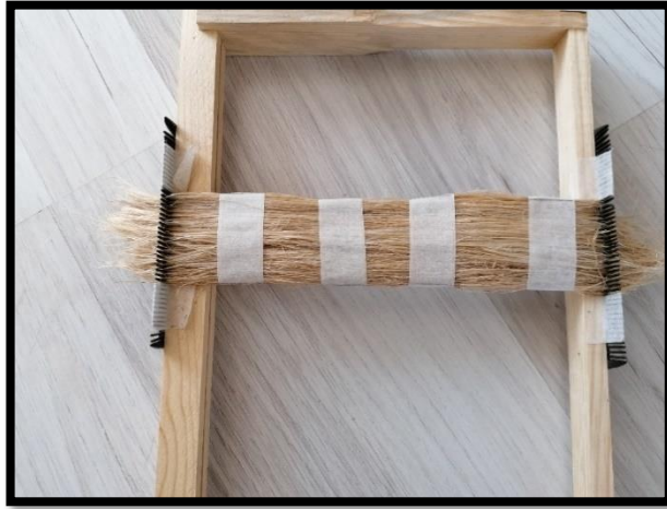
Şekil 7.1. Kenevir liflerinin boyutlandırılması
