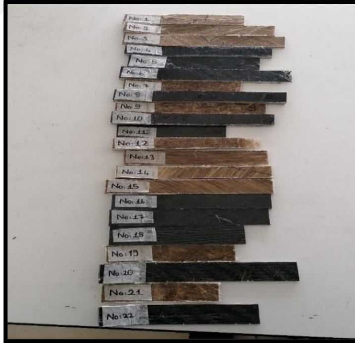
Şekil 8.3. Eğme testi uygulanan numuneler
