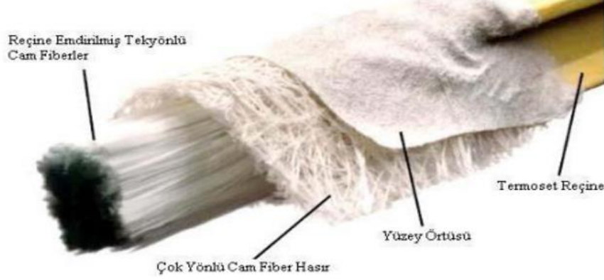
Şekil 3.12. Pultrüzyon yöntemiyle üretilmiş profil detayı
