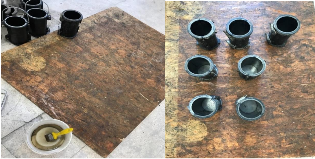
Şekil 5.15. Beton numune kalıp hazırlığı
