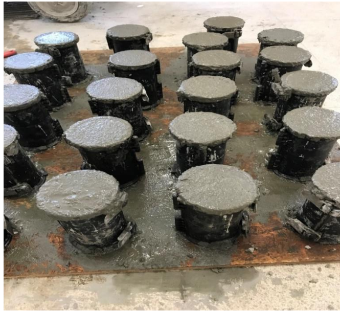
Şekil 5.17. Silindir kalıplara beton dökümü
