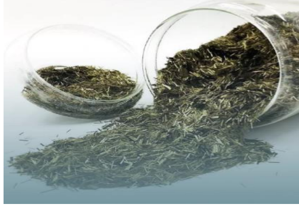
Şekil 3. 8. Bazalt lif örnek (Alihassan, 2021)
