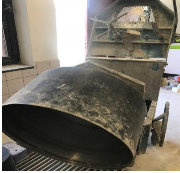
Şekil 5.7. Deneyde kullanılan beton mikseri
