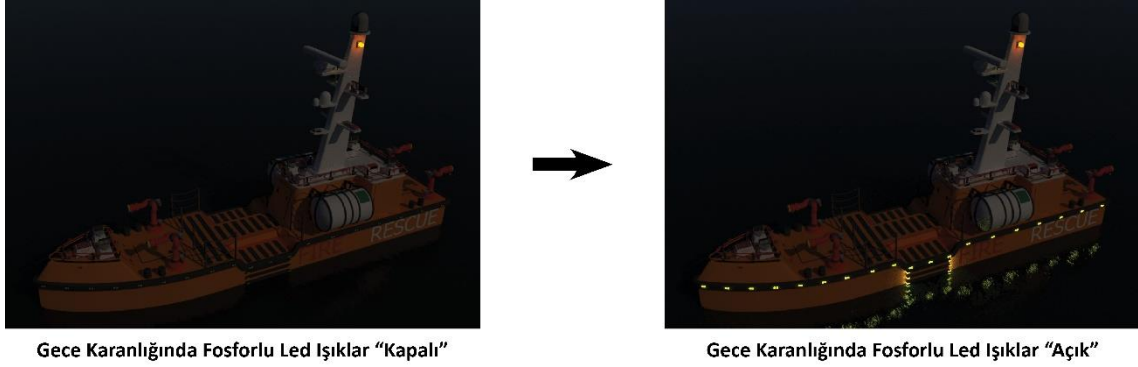
Şekil 3.8 Led Tekne Aydınlatma Sisteminin Yerleşimi ve Karanlıktaki Etkisi
