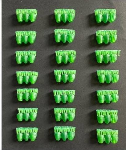
Resim 22. Üç boyutlu yazıcıdan lityum disilikat köprü restorasyonların presslenmesi için basılan döküm reçineleri ( soldan sağa doğru 12 mm 2 , 16 mm 2 , 20 mm 2 )
