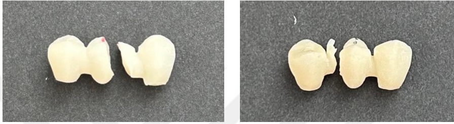
Resim 35. Lityum disilikat örneklerde tespit edilen F1 kırıklar
