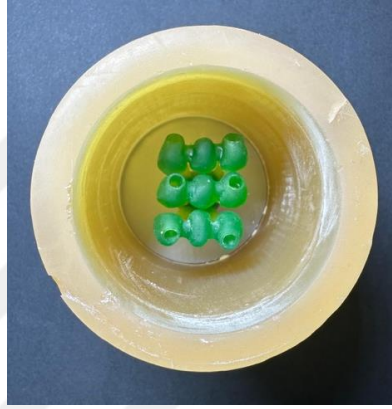
Resim 24. Döküm reçinelerinin manşete alınması
