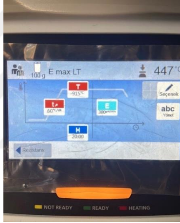
Resim 14. e.max press ingotların pressleme değerleri
