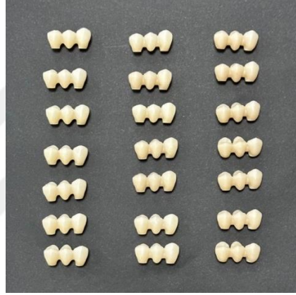
Resim 19. Sinterizasyon sonrası monolitik zirkonya restorasyonlar ( soldan sağa doğru 9 mm 2 , 12 mm 2 , 15 mm 2 'lik gruplar )
