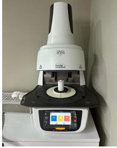
Resim 13. Çalışmada kullanılan porselen press fırını
