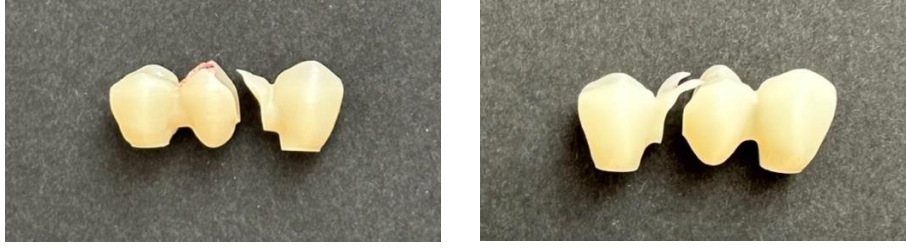
Resim 34. Monolitik zirkonya örneklerde tespit edilen F1 kırıklar
