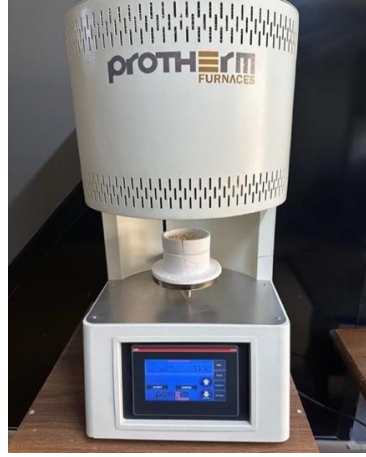
Resim 18. Sinterizasyon için kullanılan fırın
