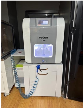
Resim 15. Çalışmada kullanılan laboratuvar tipi kazıyıcı
