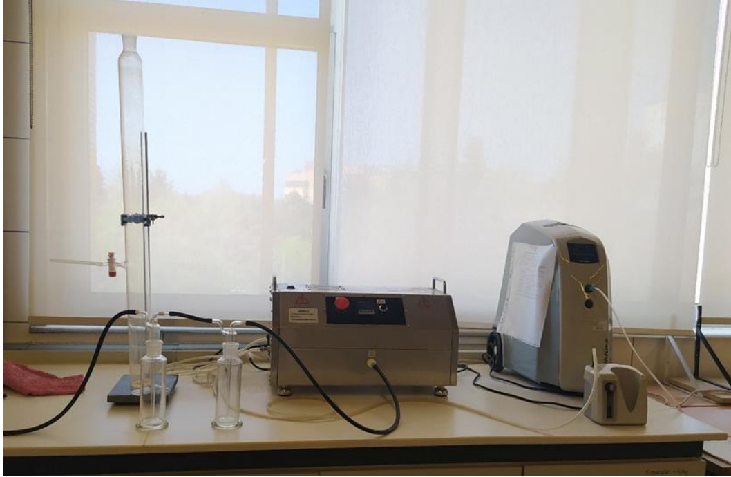
Şekil 3.1: Ozonlama sistemi: (a) Şematik gösterim; (b) Laboratuvar ölçekli deneysel sistem.
