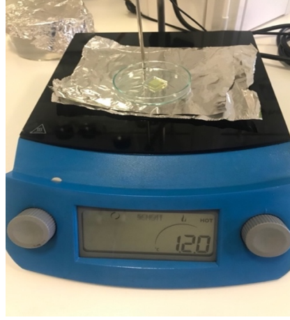
Şekil 7.6 FTO cama kaplanmış \text{TiO}_2 'nin çözücüsünün ısıtıcıda uçurulması
