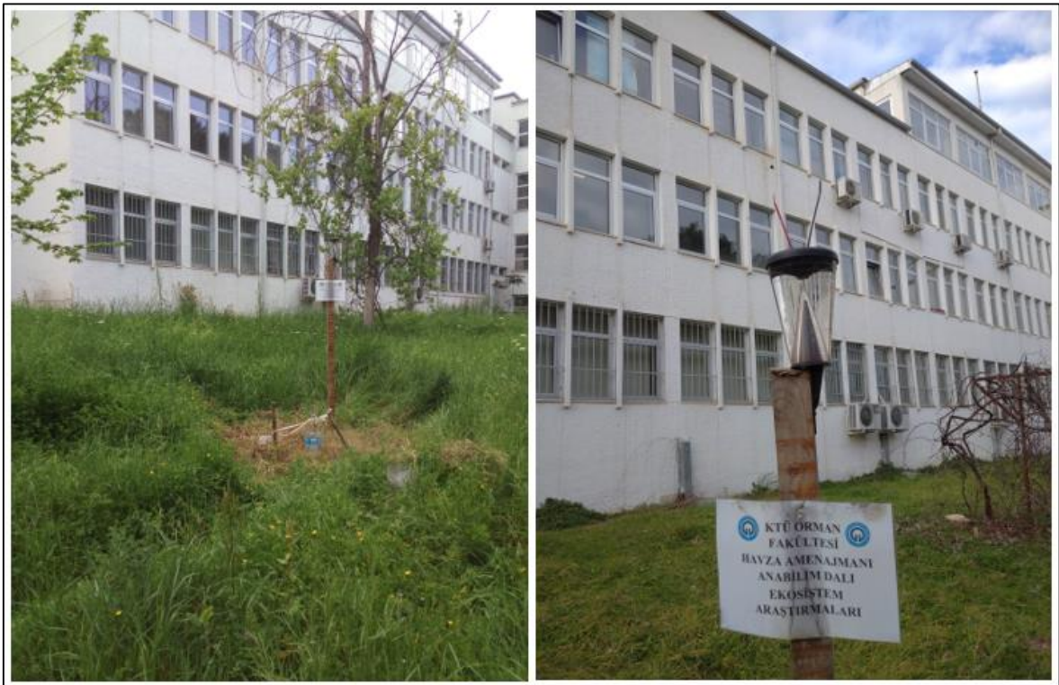
Şekil 3. Açık alana kurulan (kontrol) su toplama düzeneği
