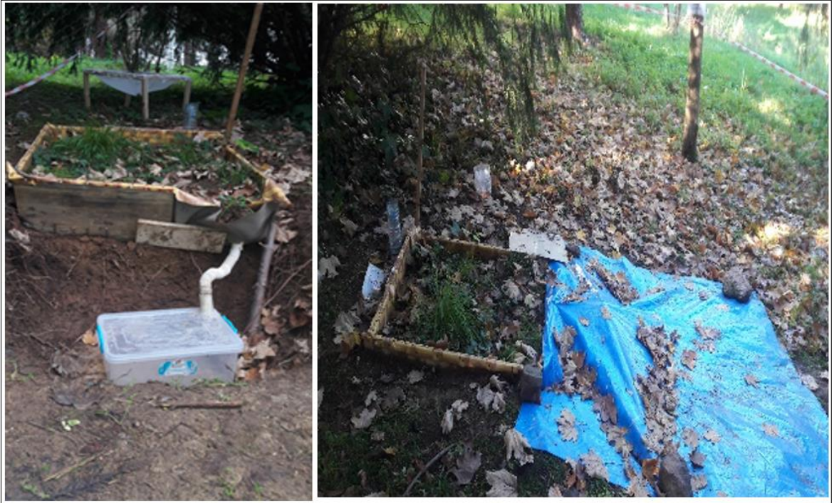
Şekil 5. Adi porsuk deneme alanı yüzey altı akış toplama düzeneği
