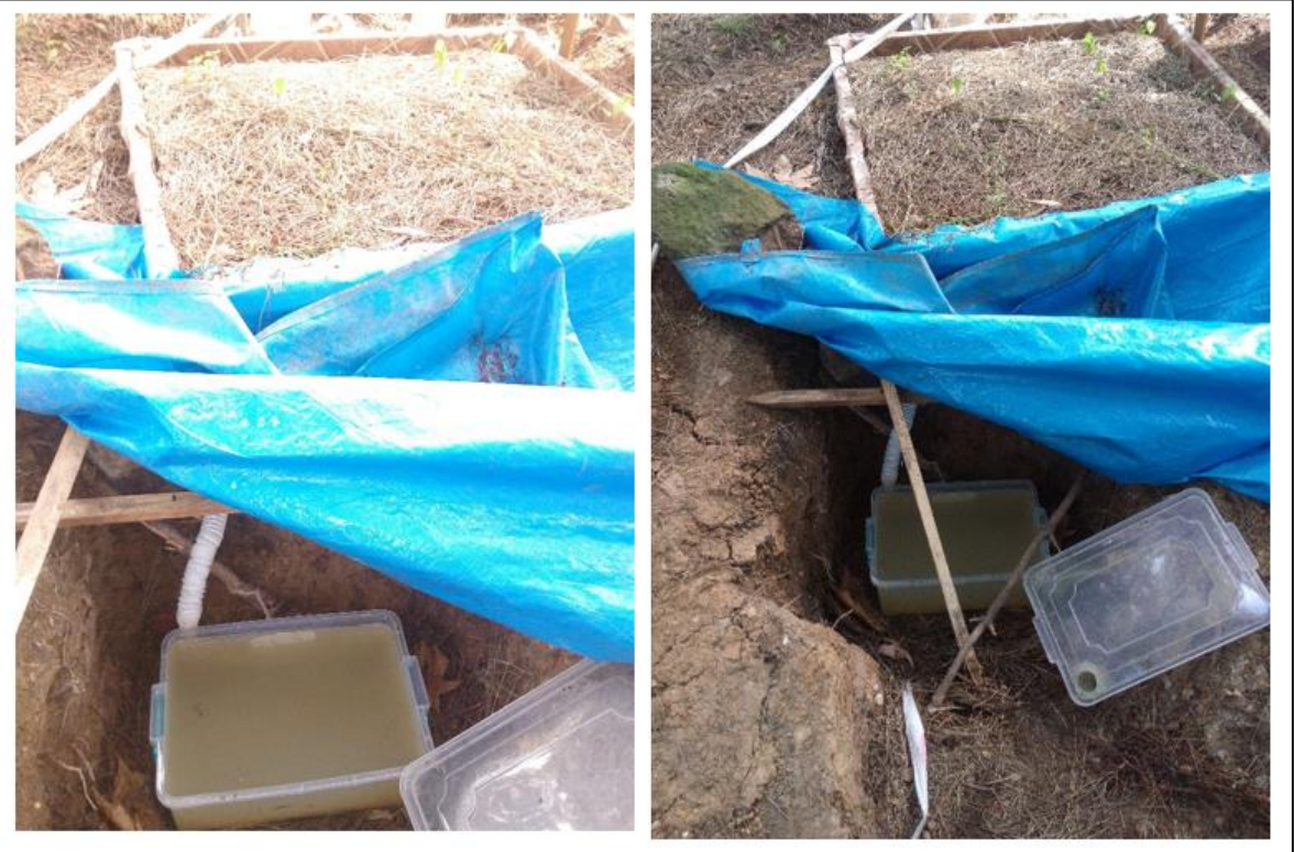
Şekil 7. Fıstık çamı deneme alanı yüzey altı akış toplama düzeneği
