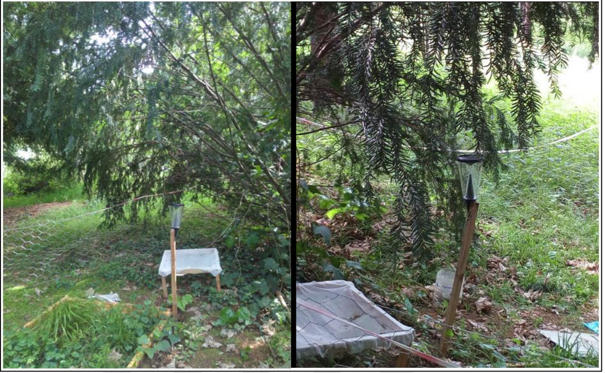
Şekil 4. Adi porsuk deneme alanı meşcere altı akış toplama düzeneği
