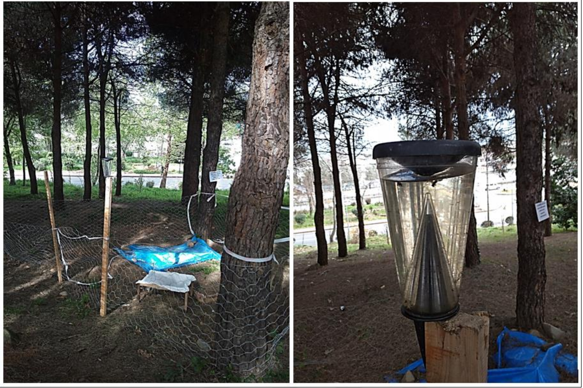
Şekil 6. Fıstık çamı deneme alanı meşçere altı akış toplama düzeneği
