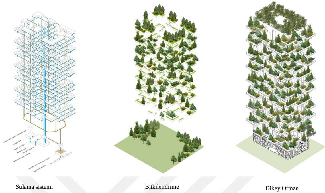
Şekil 2.19 Dikey Ormanda Sulama Sistemi Örneği Bosco Verticale (WEB_13,2021)
