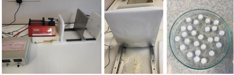
Şekil 20. Elektroegirme düzeneği ve membranların iskele tutuculara yerleştirilmesi.
