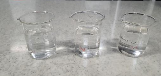
Şekil 14. Çiplerin temizlenmesi: çipler sırasıyla isopropil alkol, etanol ve su yıkamalarına maruz bırakılarak kirlilikler ve kalıntılar uzaklaştırılmıştır.
