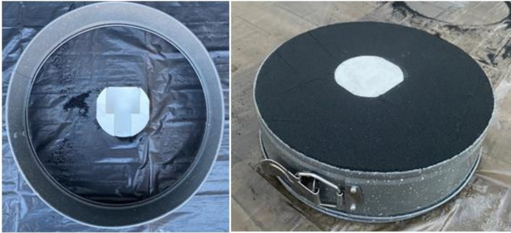
Şekil 9.11. a) Ağırlık modelin kalıp içerisine yerleştirilmesi. b) Kum ile kalıplanmış model.
