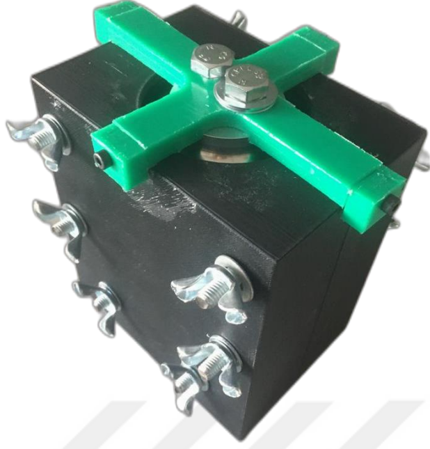
Şekil 8.13. Maça, maça tutucu, kalıp görünümü.
