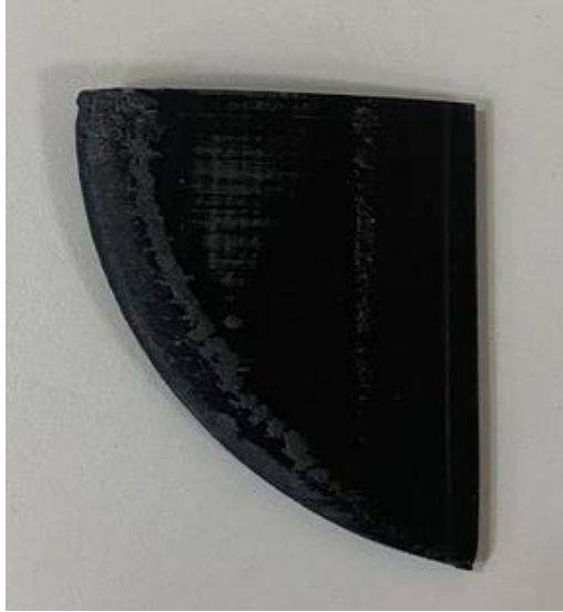
Şekil 8.9. Üç boyutlu yazıcı ile üretilen karın yüzgeci.
