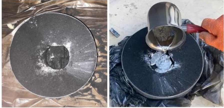
Şekil 9.12. a) Modelin kumdan çıkartılması b) Kalıba kurşun dökümü.
