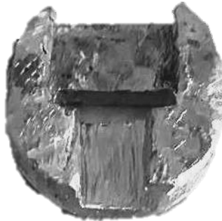
Şekil 9.14. Tel aktarım boşluklarının açıldığı kurşun ağırlık modeli.
