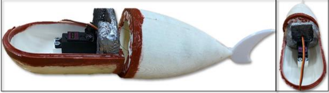
Şekil 9.15. Kurşun ağırlığın gövdeye montajı.
