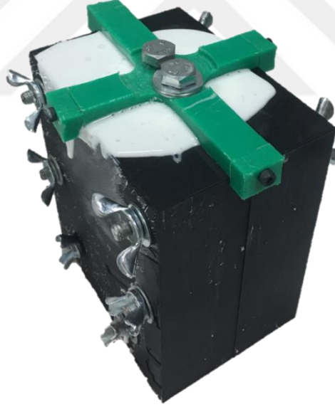
Şekil 8.14. RTV-2 silikonun kürlenmesi.
