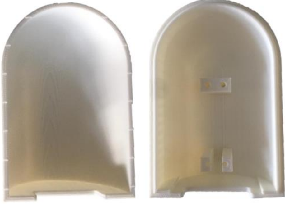
Şekil 8.8. Üç boyutlu yazıcı ile üretilen gövde parçaları
