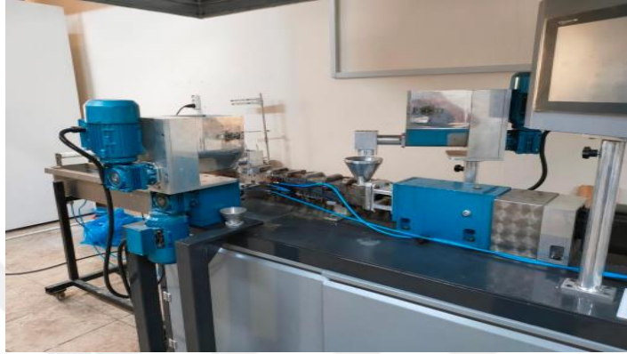
Şekil 2.3: Kompozit hazırlamada kullanılan ekstrüder (BTÜ-Polimer Malzeme Müh. Lab).
