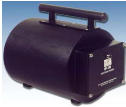
Şekil 2.9: Deneyde kullanılan Canberra NP100B nötron dedektörü.
