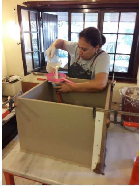
Resim 65. Alçı kalıpların dökülmesi
