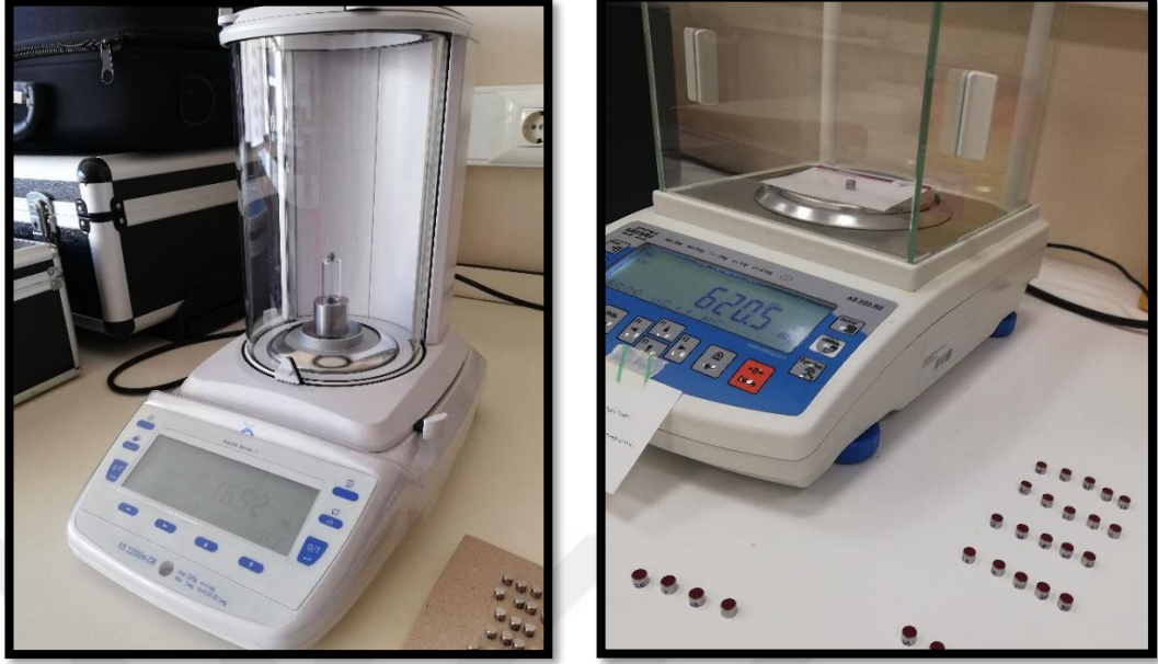
Resim 3.8: Hassas teraziler; a) Precisa ES 225Sm-DR Semi Mikro Terazi, İsviçre, b) Radwag 220.R2 Analitik Terazi, Polonya
