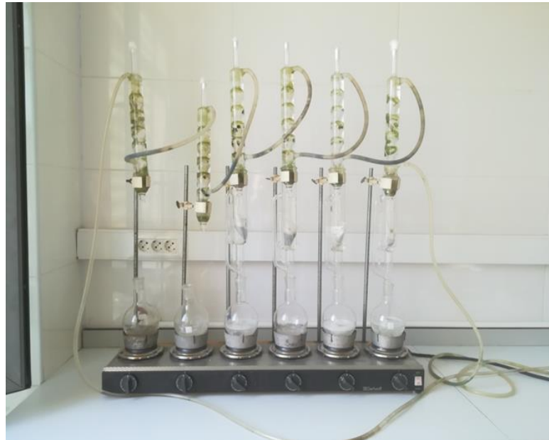
Şekil 2.4. Yağ analizinde kullanılan soxhlet cihazı
