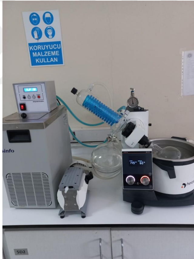
Şekil 2.6. Rotaryde hekzan temizleme aşaması
