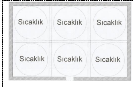
Şekil 3.13. Çok kubbeli sıcaklıklı tip şematik gösterim (Karaman, 2013)
