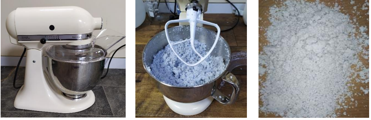
Şekil 3.5. Hobart tipi yoğurma cihazı, dispersiyon işlemi ve dispers olmuş hamurlar
