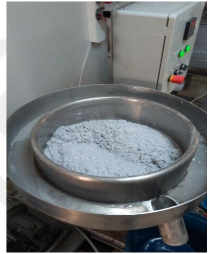
Şekil 3.1. Hamurlaştırma işleminde kullanılan pulper ve bıçak yapısı
